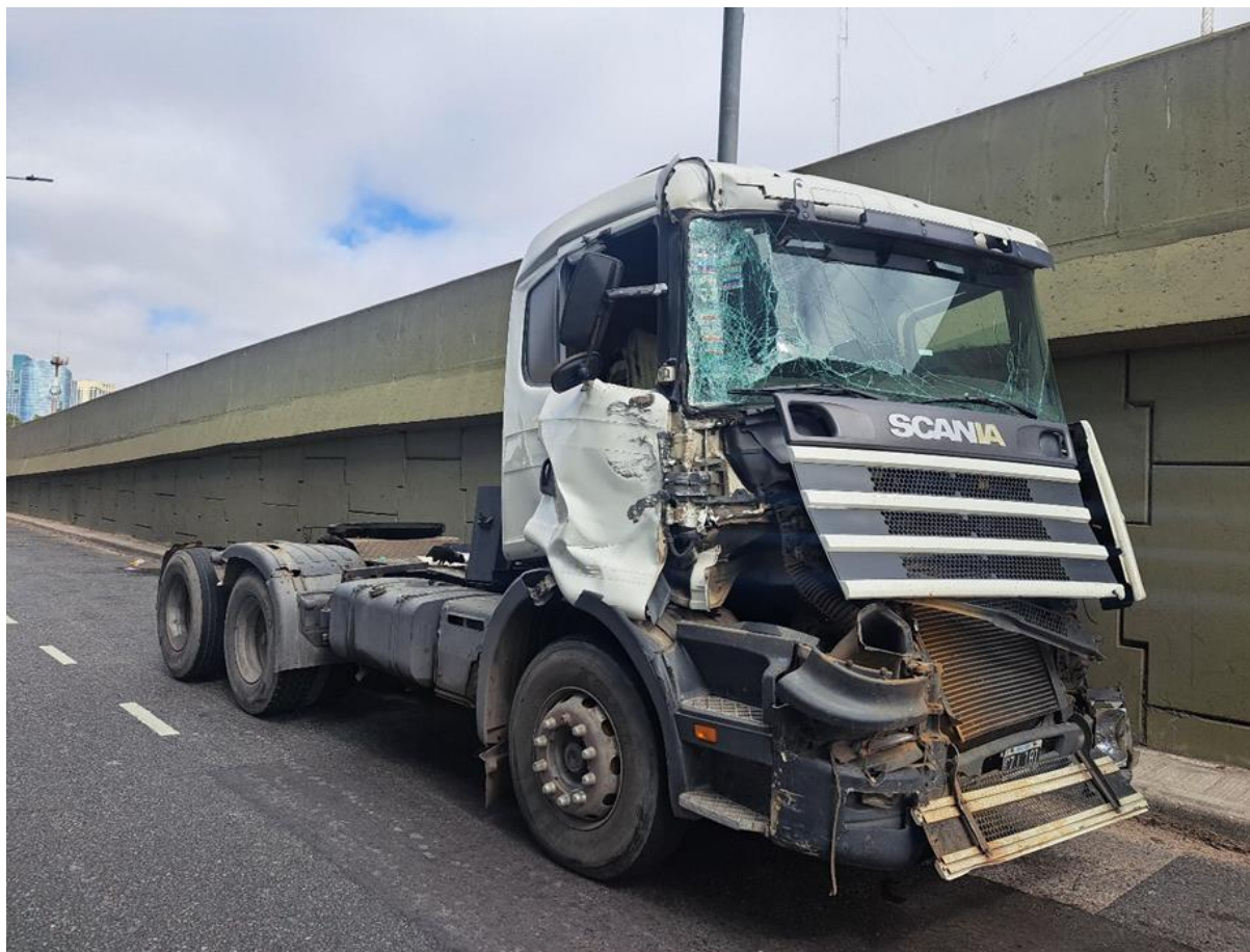
Figura 1. Daños en el Vehículo 2. Fuente: JST, 2024
