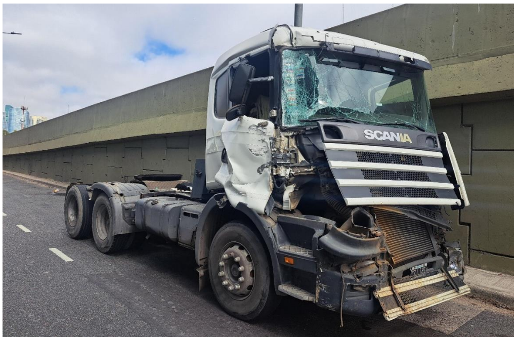
Figura 7. Daños en el sector anterior del Vehículo 2 con mayor incidencia en el tercio derecho con proyección sobre el lateral derecho. Fuente: JST, 2024
