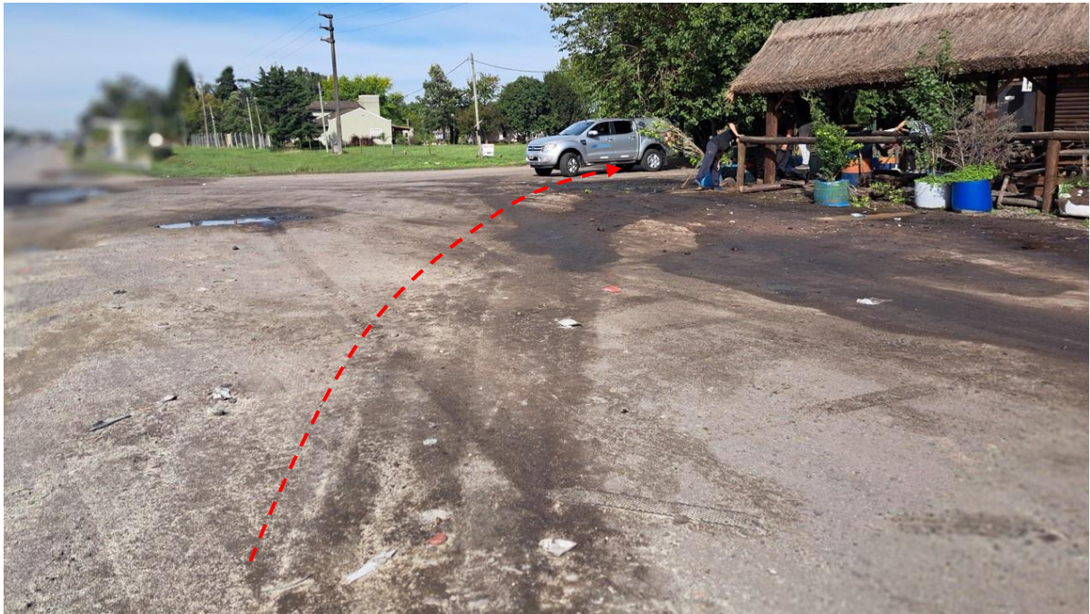
Figura 30. Finalización de la mancha dinámica de fluidos mecánicos del Vehículo 2. Fuente: JST, 2024
