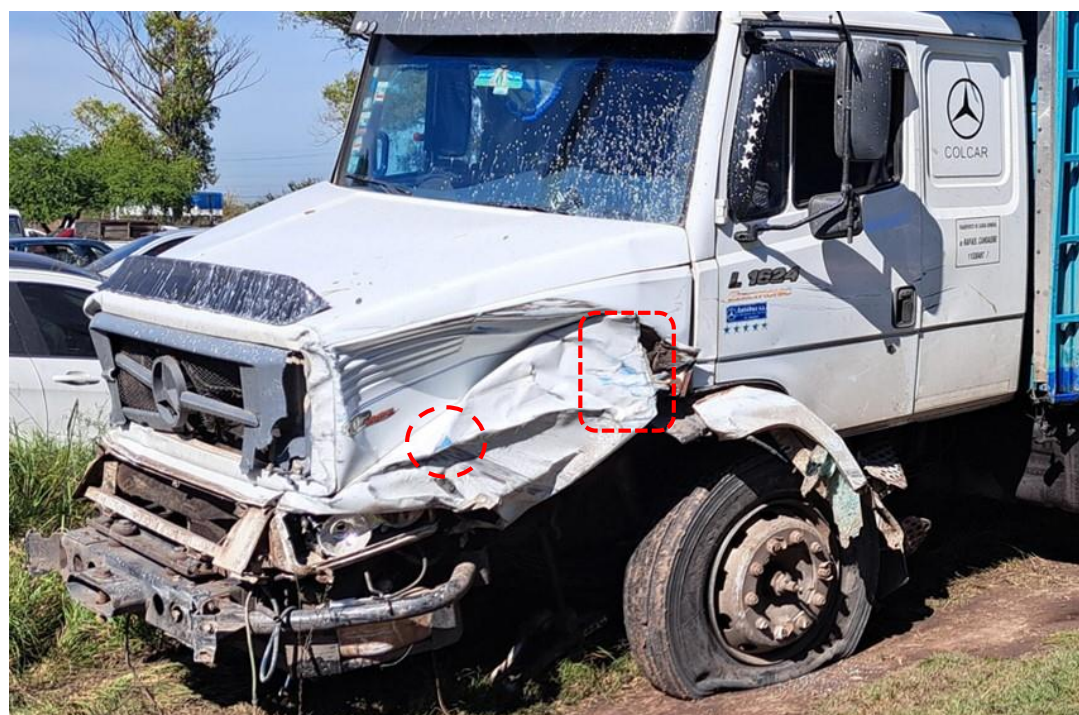
Figura 11. Detalle de la transferencia de pintura azul del Vehículo 4. Fuente: JST, 2024
