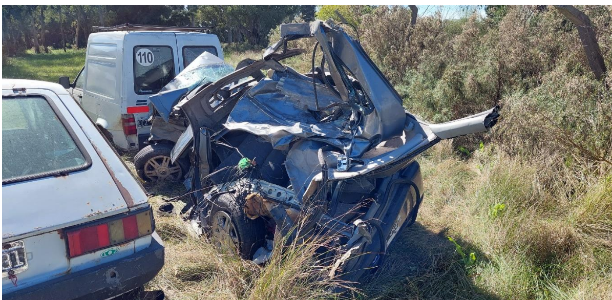
Figura 7. Vista de las deformaciones del sector posterior y del lateral izquierdo del Vehículo 1. Fuente: JST, 2024
