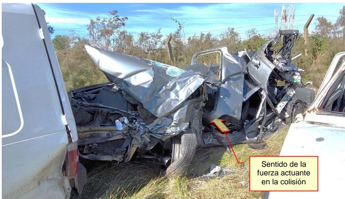
Figura 6. Vista de las deformaciones del sector anterior y del lateral izquierdo del Vehículo 1. Fuente: JST, 2024
