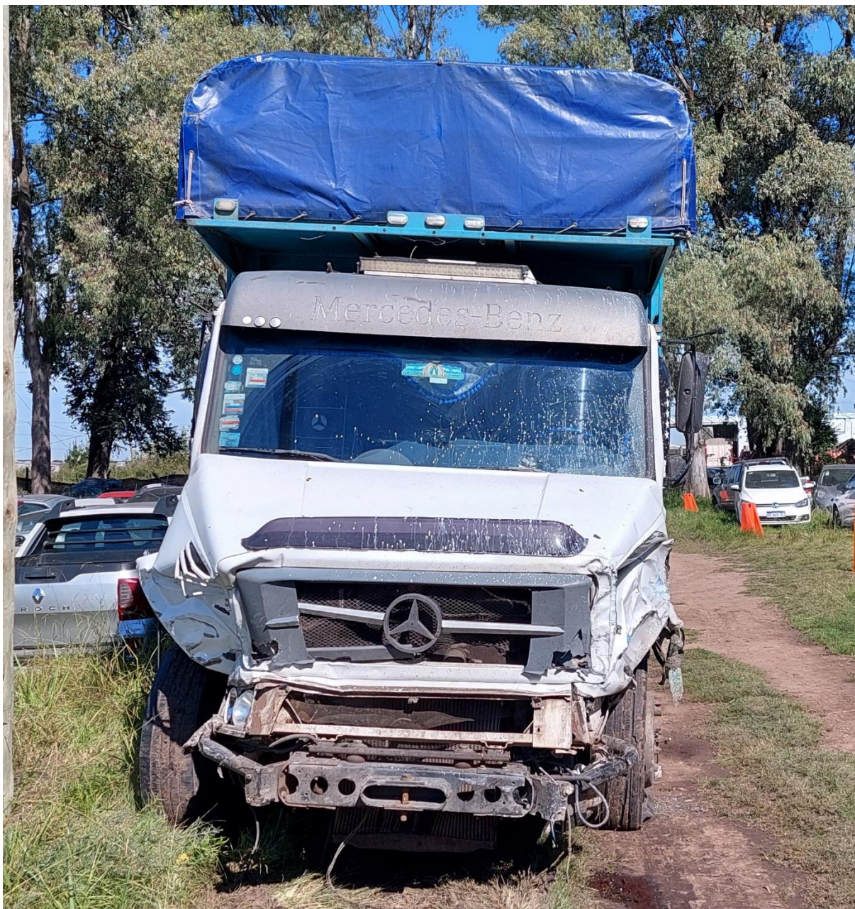
Figura 9. Daños por impactos directos en los tercios izquierdo y derecho del sector anterior del Vehículo 2. Fuente: JST, 2024
