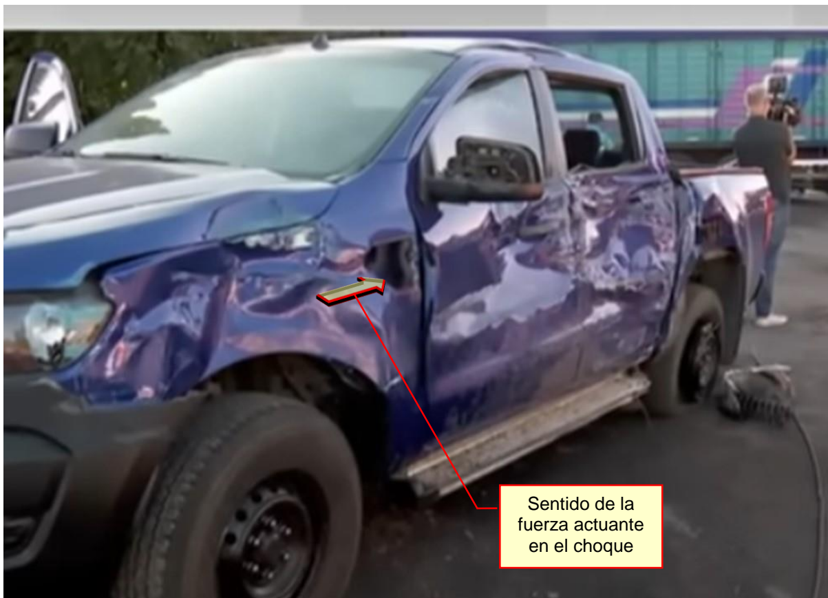
Figura 14. Daños que adquirió le Vehículo 4 en el choque del Vehículo 2. Fuente: Captura de imagen de video de YouTube , 2024
