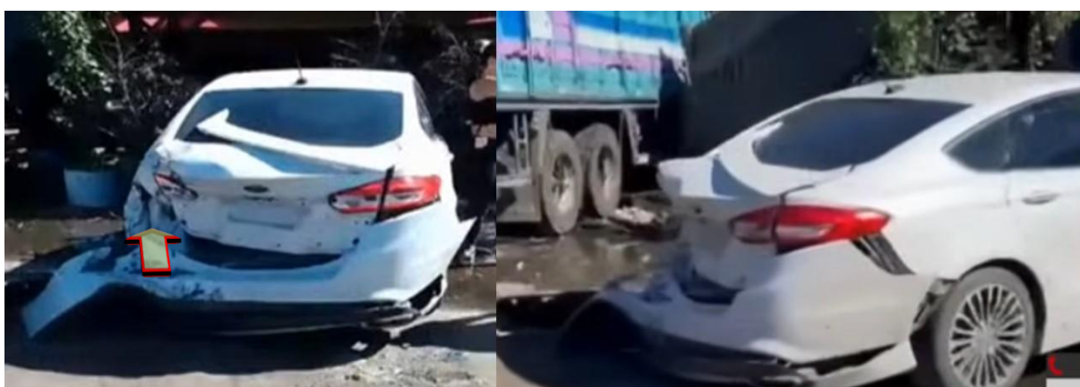
Figura 15. Daños que adquirió el Vehículo 5 en el choque del Vehículo 2. La flecha indica el sentido de la fuerza actuante en la deformación. Fuente: Captura de imagen de video de YouTube , 2024
