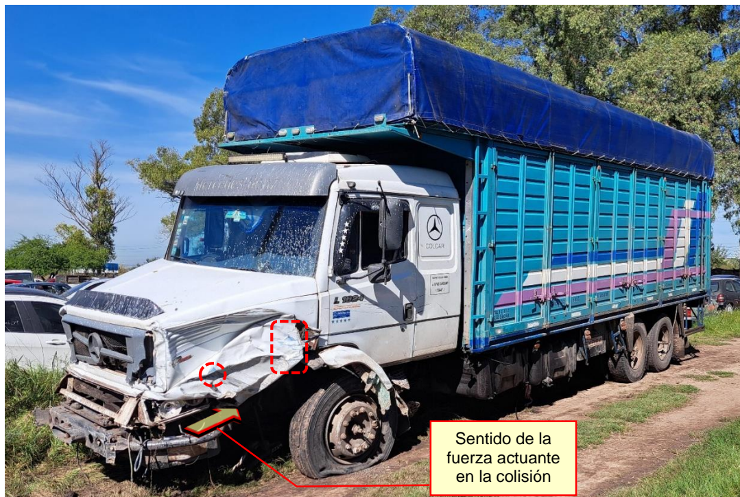
Figura 10. Daños en el lateral izquierdo indicándose la transferencia de pintura azul. Fuente: JST, 2024
