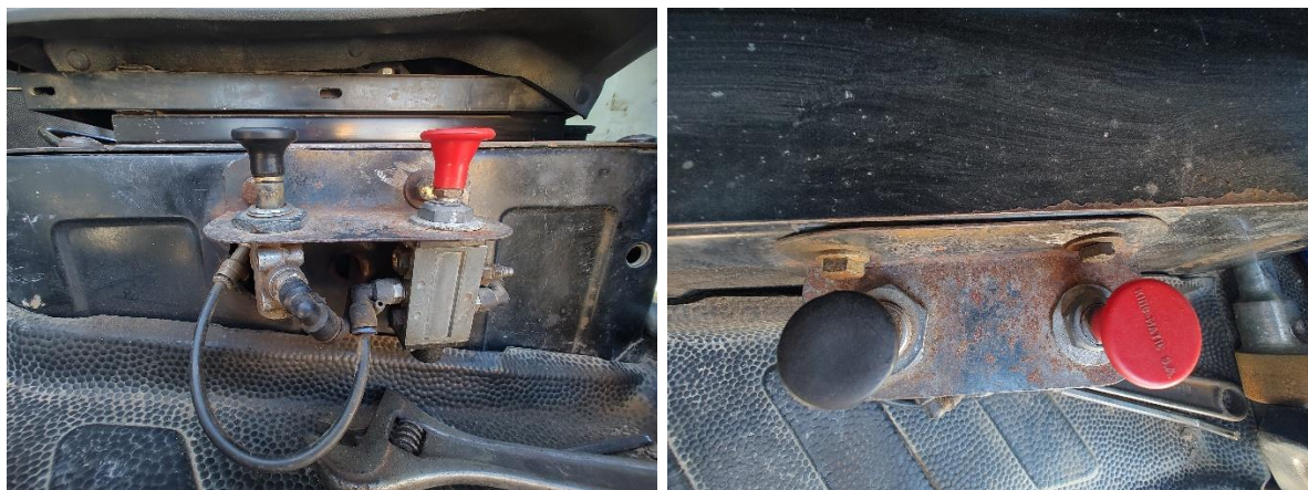
Figura 7. Botones de accionamiento del sistema hidráulico de la batea en el interior de la cabina de conducción. El rojo corresponde a la toma de presión y el negro al de liberación del líquido hidráulico.
