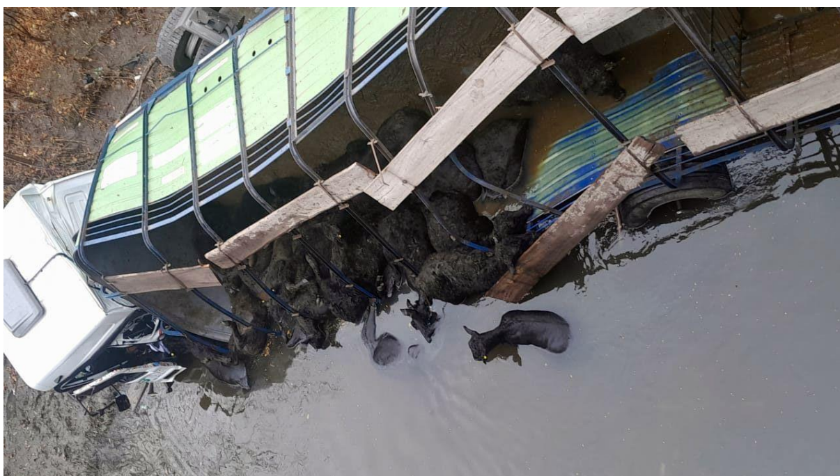
Figura 10. Afectaciones en la zona superior y lateral izquierdo del semirremolque. Además, se verifican daños en la zona posterior de la cabina de la unidad tractora. Fuente: Noticias mercedinas , 2024
