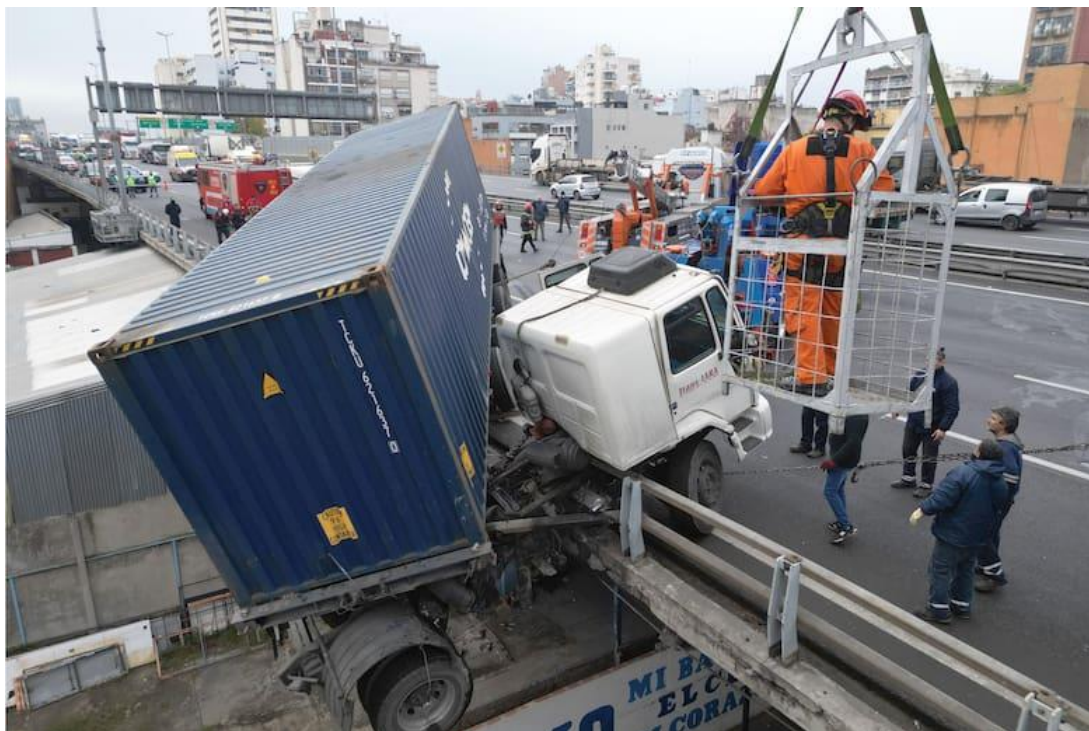
Figura 11. Posición final del Vehículo 1, colgando de la autopista 25 de Mayo. Se observa el sector posterior del camión tractor y sector anterior del semirremolque en el aire. Fuente: La Nación , 2024
