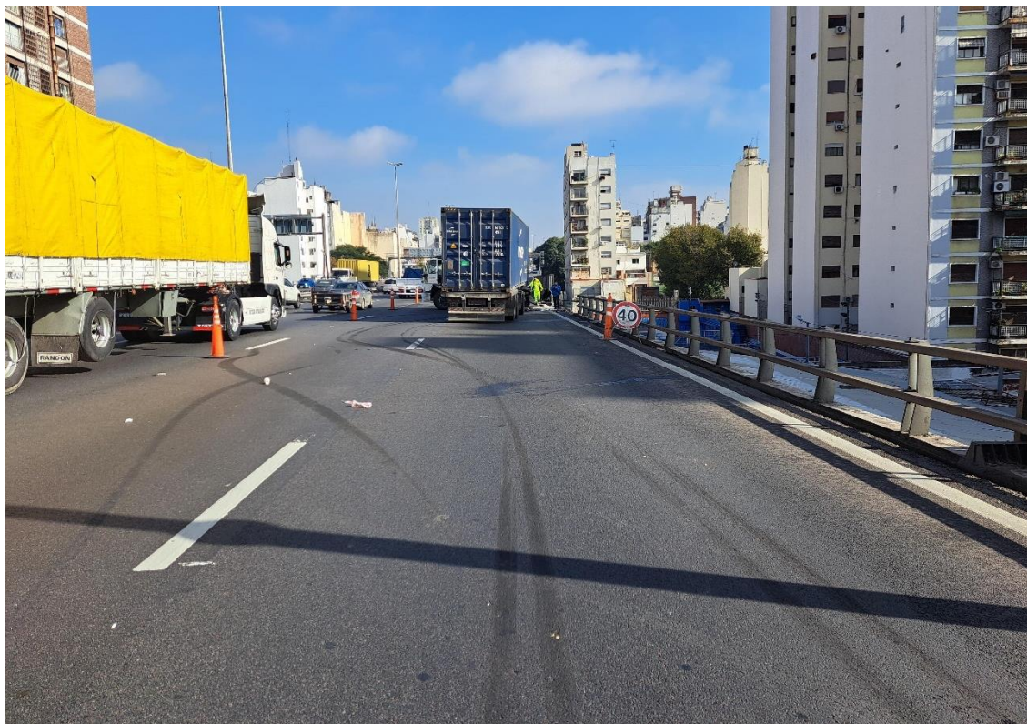
Figura 10. Cruce de huellas en dos carriles (derecho y central-derecho) producido por el giro antihorario de la unidad tractora. Fuente: JST, 2024
