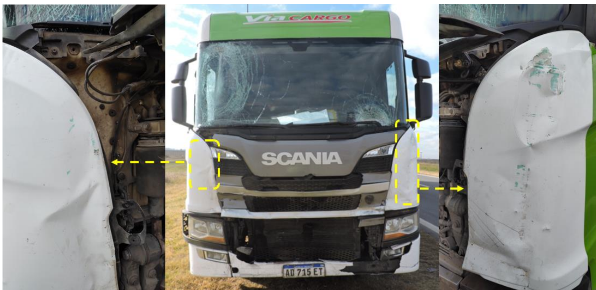
Figura 7. Daños en la parte anterior del camión tractor. Fuente: JST, 2024
