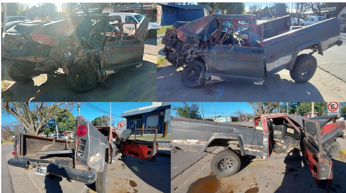
Figura 7. Daños en el Vehículo 2. Se observa en las imágenes superiores la incidencia de la deformación de derecha a izquierda. Fuente: JST, 2024
