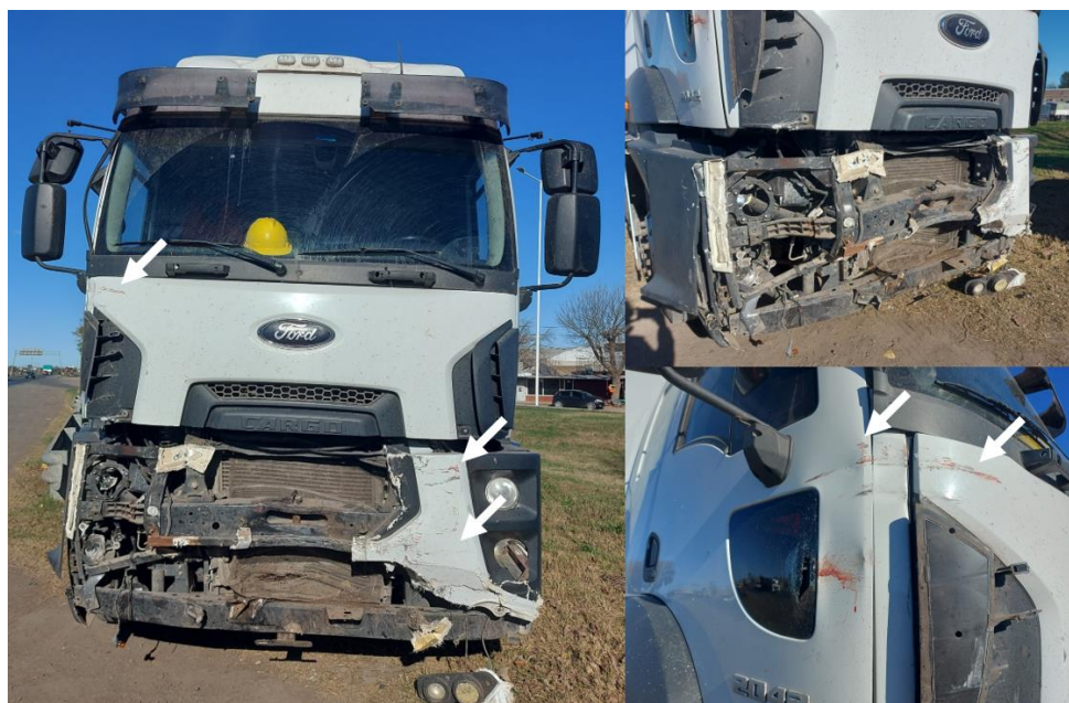
Figura 6. Daños en la parte anterior del camión tractor. Se señalan con flechas algunas de las transferencias de pintura halladas. Fuente: JST, 2024
