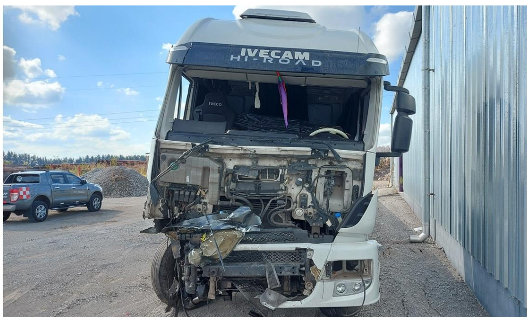
Figura 10. Daños en el sector anterior del Vehículo 1. Fuente: JST, 2024
