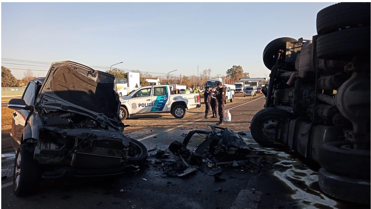
Figura 16. Sector anterior del Vehículo 2 con daños y desprendimiento de carrocería. Fuente: JST, 2024
