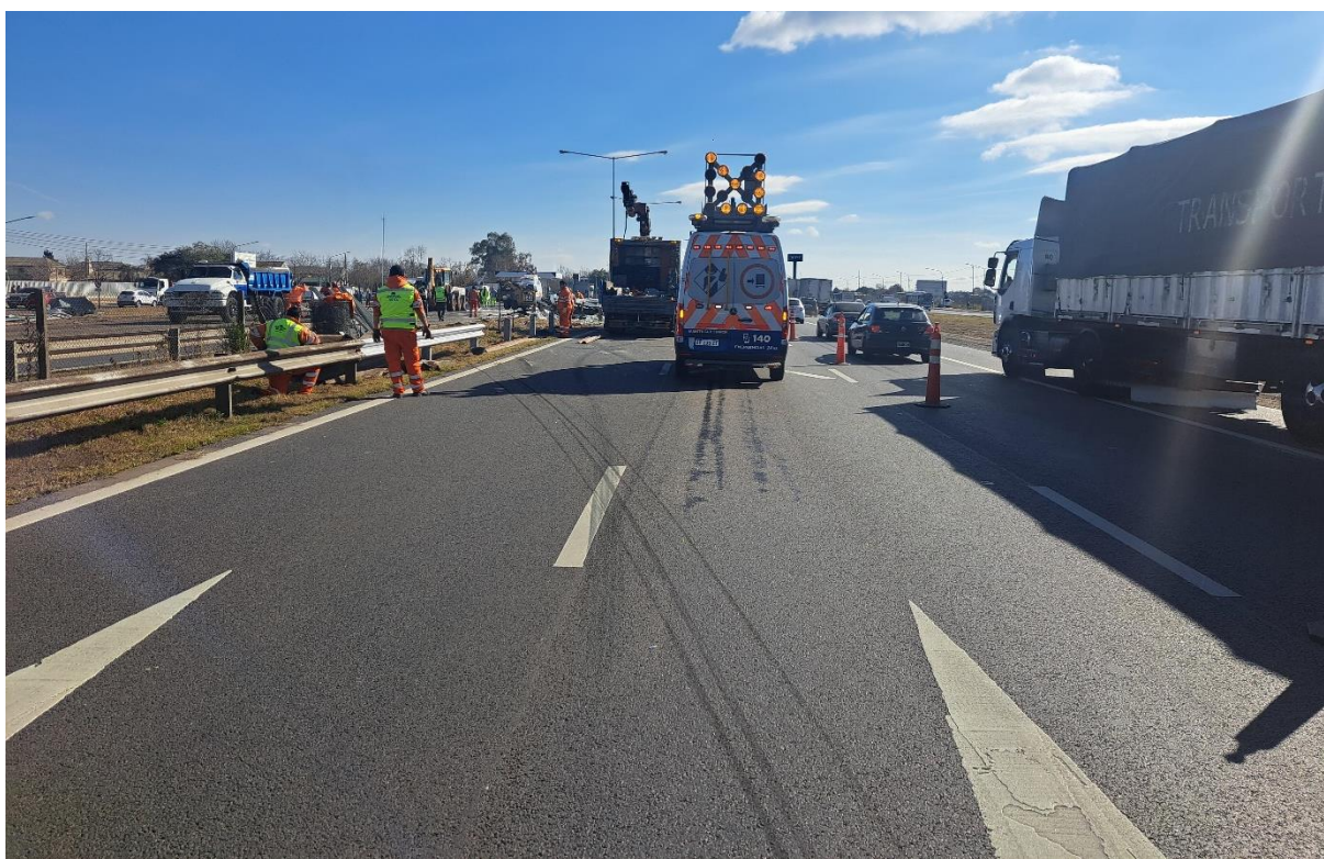
Figura 18. Continuación de la huella de derrape del Vehículo 1 en dirección al cantero central. Fuente:
