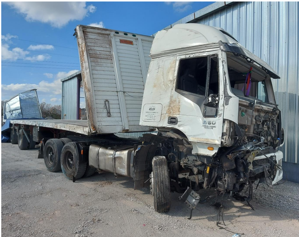
Figura 11. Daños en el lateral derecho del Vehículo 1. Fuente: JST, 2024
