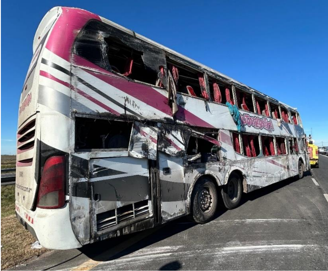
Figura 7. Vista de los daños en el lateral derecho del Vehículo 1. Fuente: JST, 2024
