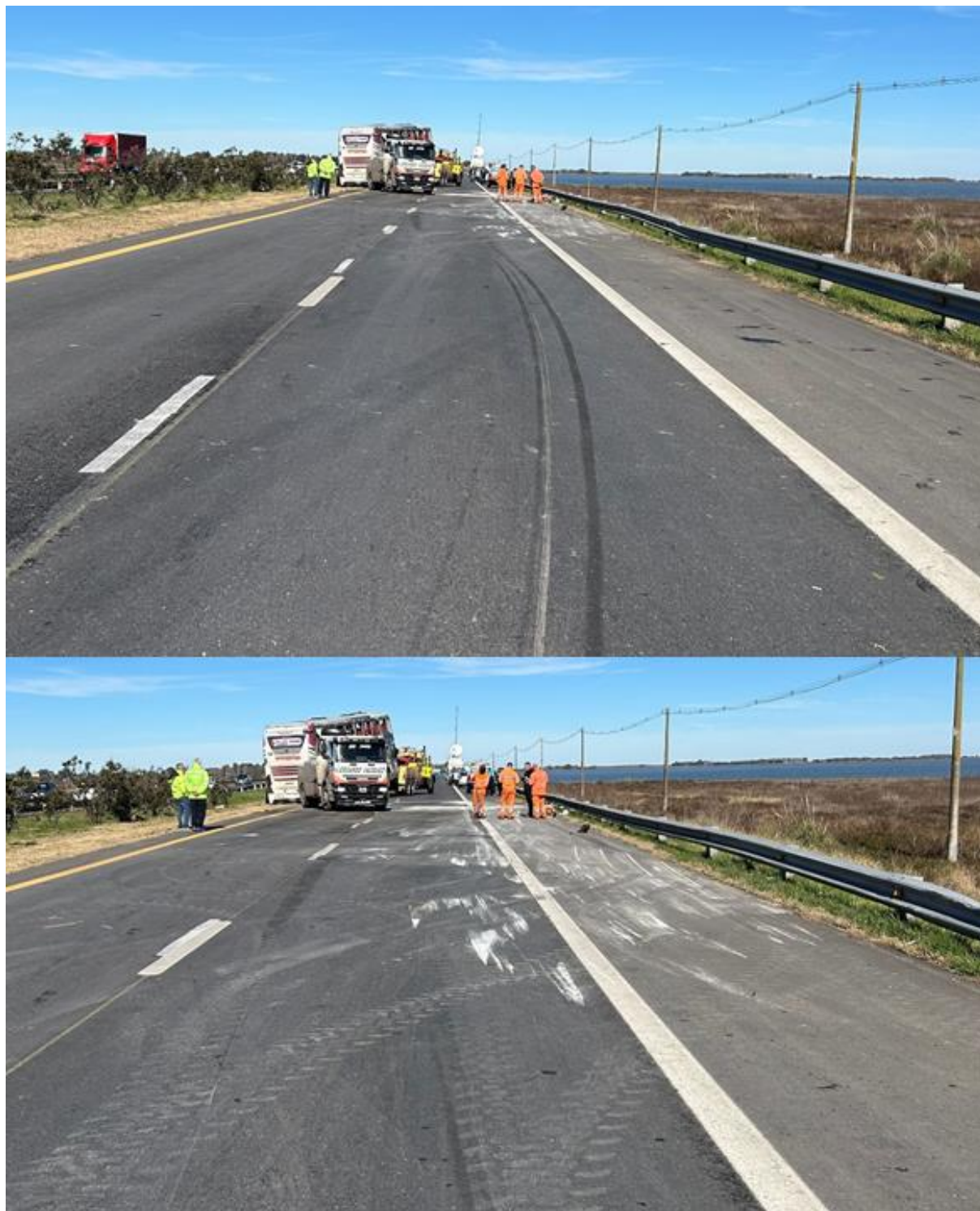
Figura 14. Imágenes con sentido hacia Castelli. Superior: huellas de derrape previas al vuelco. Inferior: inicio de los rastros asociados al vuelco de la unidad. Fuente: JST, 2024
