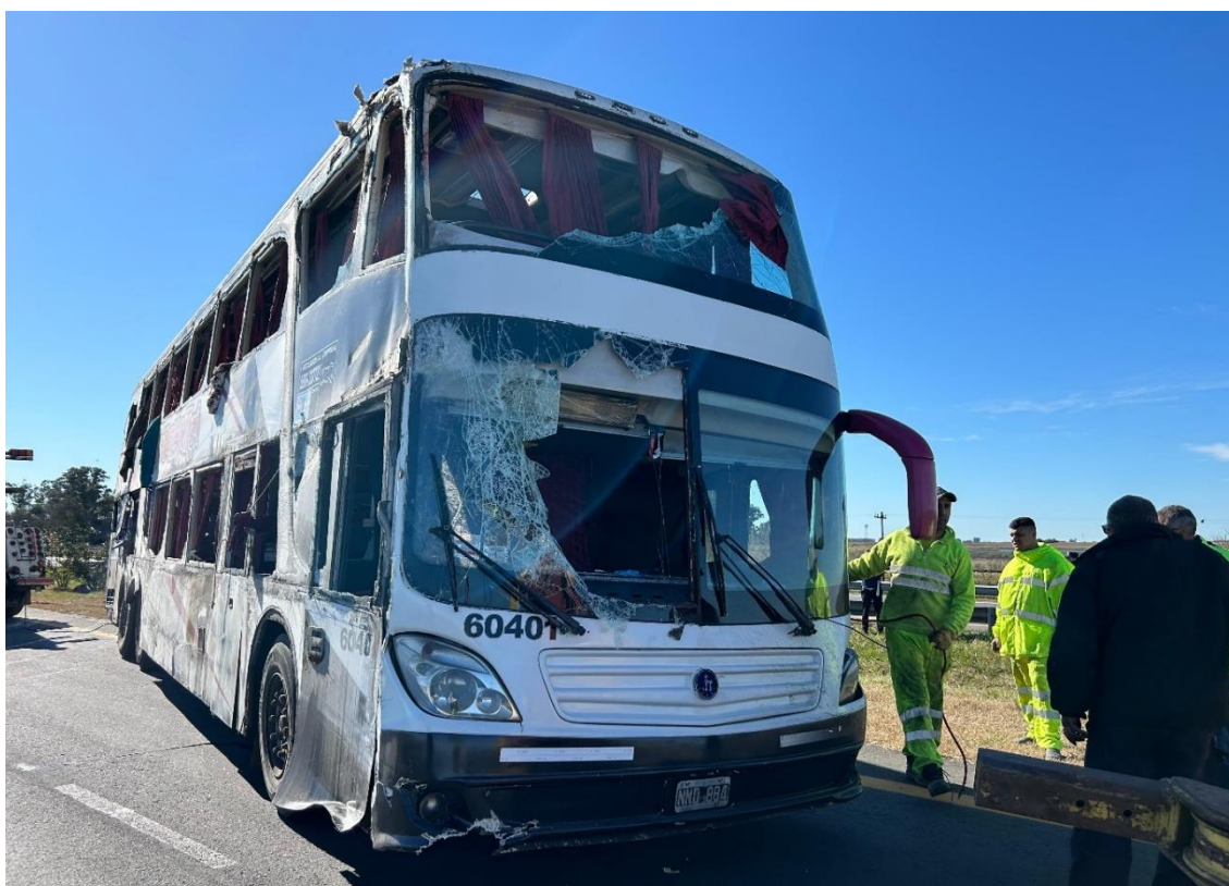
Figura 5. Vista de los daños en sector anterior del Vehículo 1. Fuente: JST, 2024
