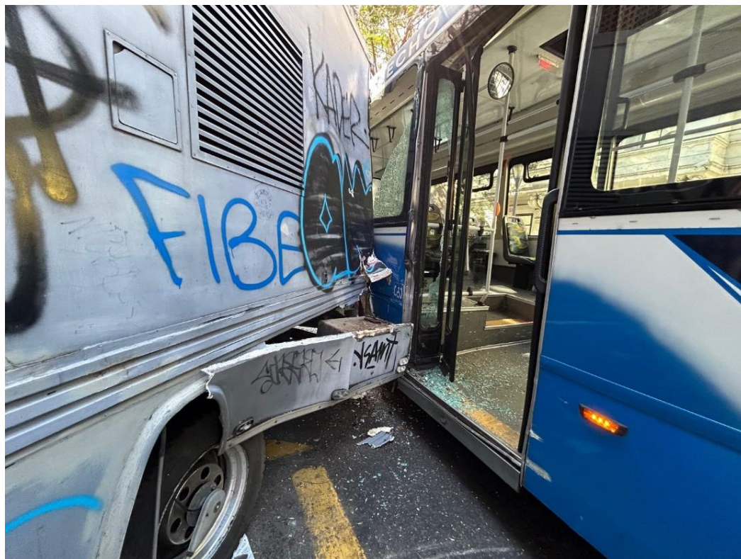
Figura 9. Daños en el Vehículo 2. Fuente JST, 2024
