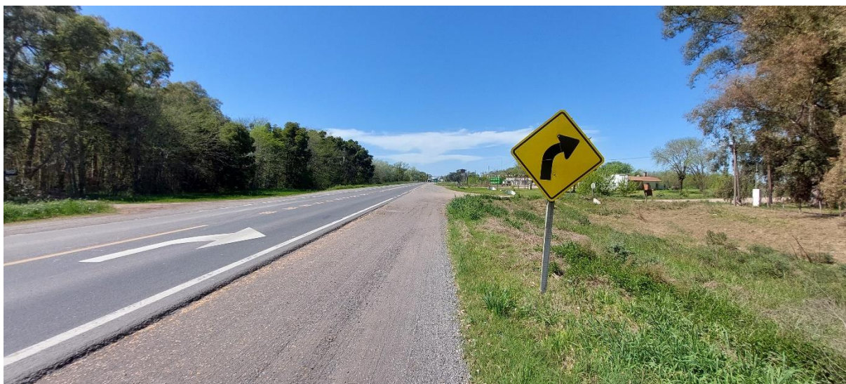
Figura 8. Señalización horizontal y vertical de curva a la derecha para el sentido de circulación hacia Mercedes a 250 m de la zona de colisión. Fuente: JST, 2024
