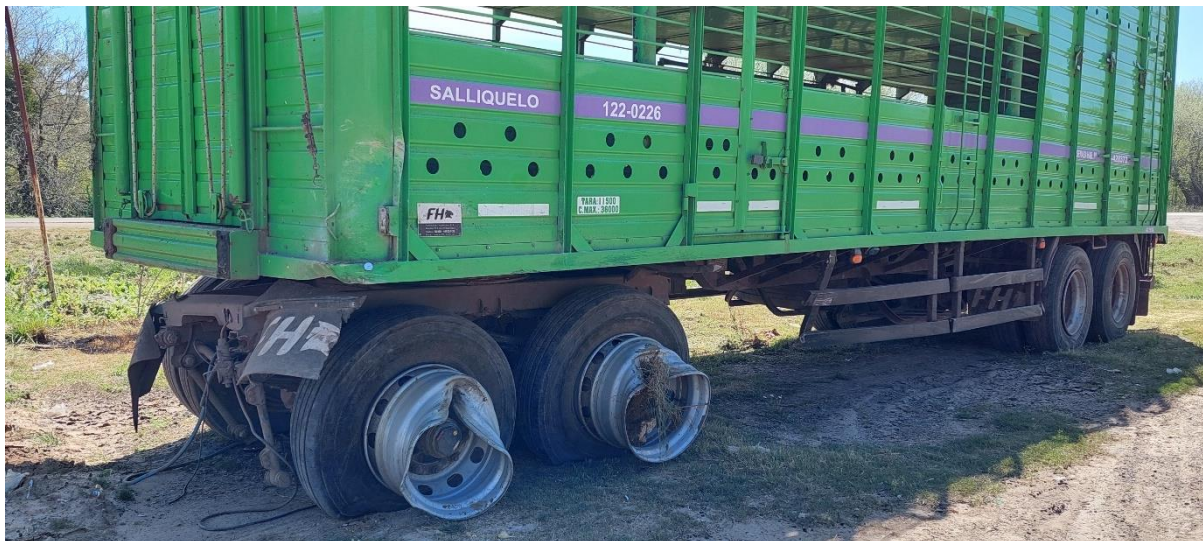
Figura 14. Daños y transferencia de pinturas que generó la colisión con el Vehículo 1. Fuente: JST. 2024
