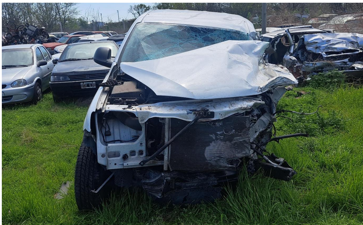
Figura 9. Daños en el sector anterior del Vehículo 1. Fuente: JST, 2024
