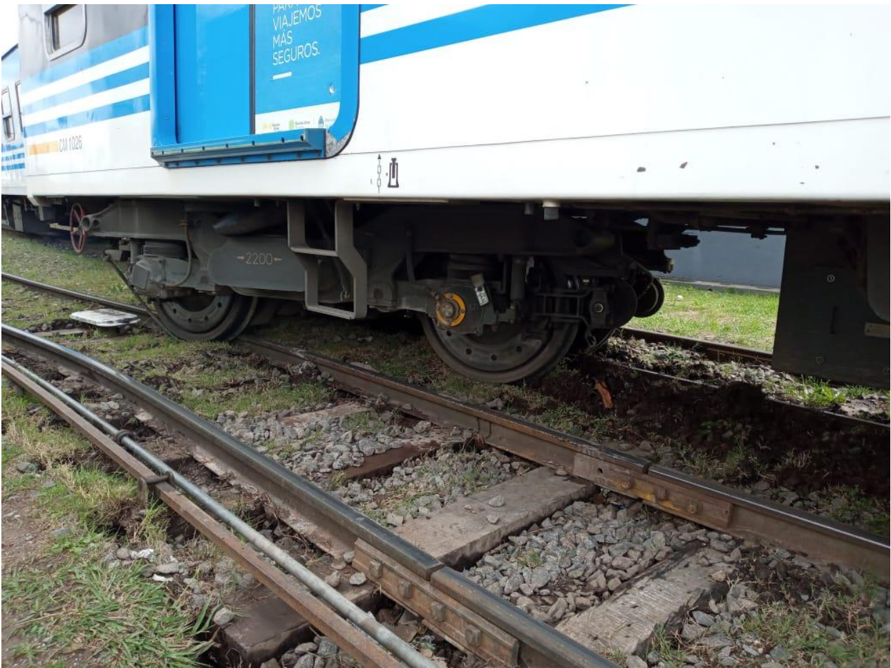
Figura 3: Detalle del bogie descarrilado, nótese que el primer eje (izquierda) es el que pierde la trocha al transitar el cambio - Fuente: Archivo JST.
