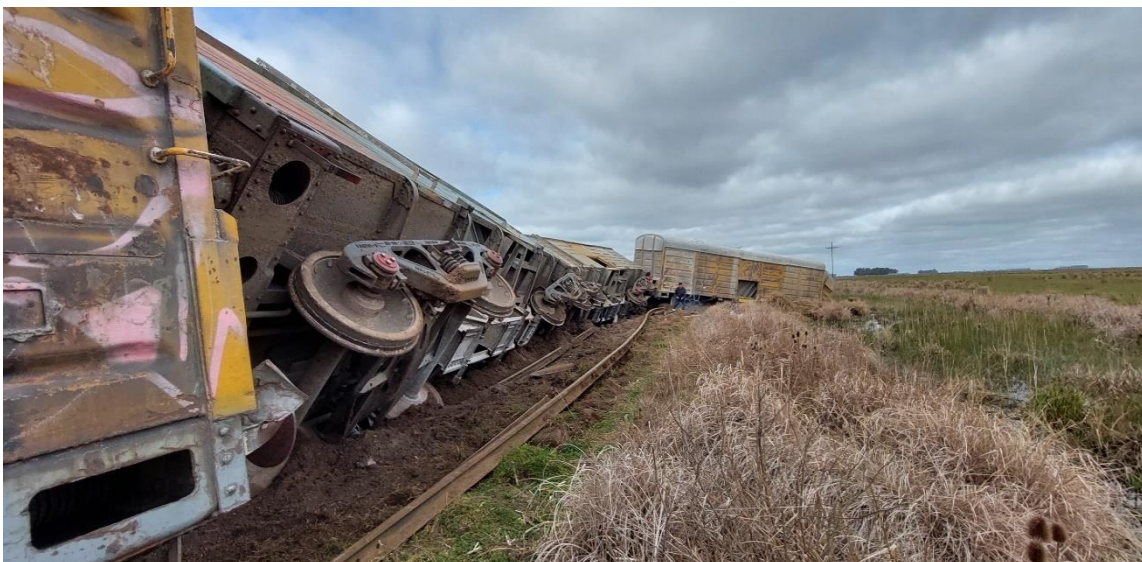
Figura 3. Vagones del tren de carga N° 322/164 descarrilados en cercanías de la estación Martín Colman. Fuente: JST, 2021
