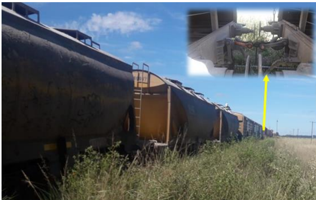
Figura 9. Tolvas cementeras y detalle del tipo de enganche a tornillo. Fuente: JST, 2021
