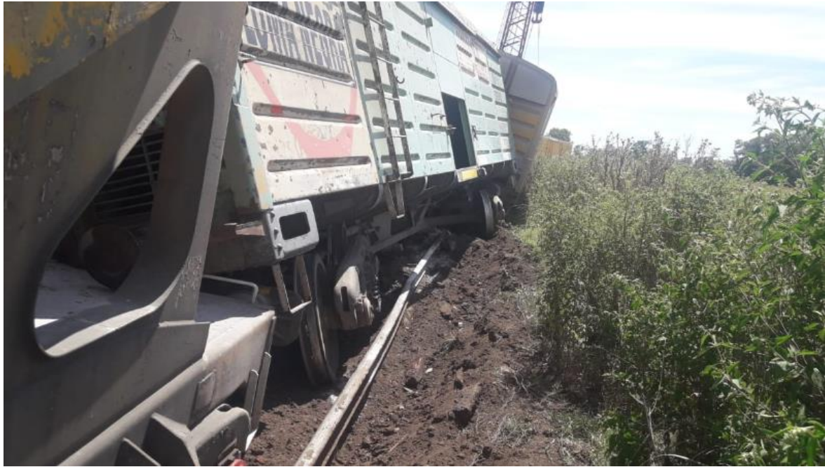
Figura 2. Bogie descarrilado del tren de carga N° 322/054. Fuente: JST, 2021
