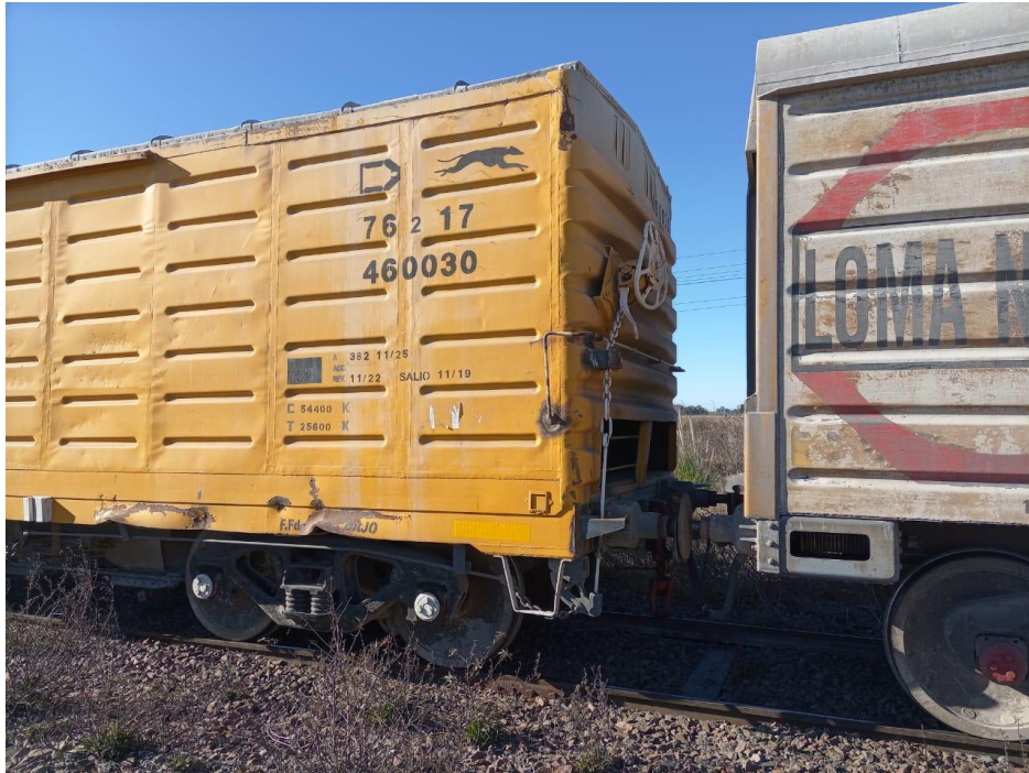
Figura 10. Vagón tipo cubierto de industria nacional, modificado a tolva cementera. Fuente: JST, 2021
