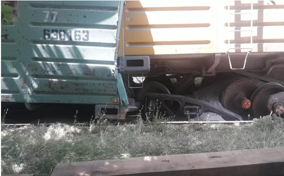
Figura 18. Daños en el vagón N° 638163 (posición 27) producido por la colisión con el vagón N° 637363. Fuente: JST, 2021
