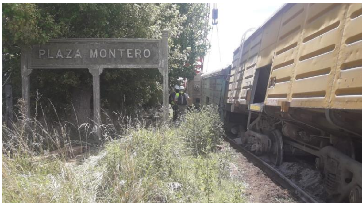
Figura 1. Vagón descarrillado en el ingreso de la estación Plaza Montero. Fuente: JST, 2021
