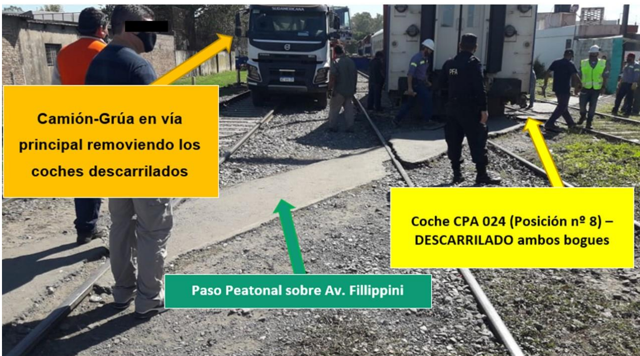
Figura 2. Coche CPA 024 (Descarrilado) atravesado sobre vías 4º, 3º y Principal Descendente, luego de ser desacoplado de los seis primeros coches, imagen tomada desde el PAN Av. Fillippini, Fuente: Archivo JST
