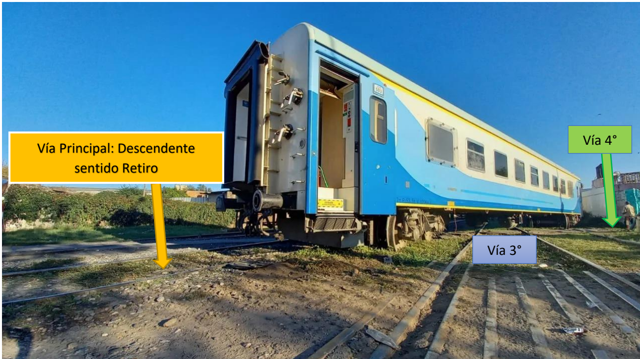
Figura 3. Coche CPA 024 (descarrilado) atravesado sobre vías 4°, 3° y Principal Descendente, luego de ser desacoplado de los seis primeros coches, Fuente: Archivo JST
