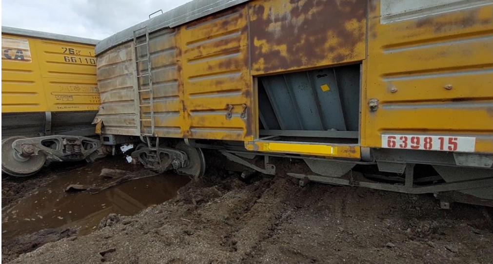
Figura 4. Presencia de agua y estado final de vagón N° 639815. Fuente: investigadores JST
