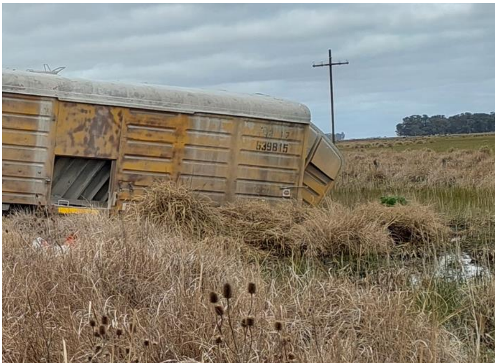
Figura 3. Vegetación en terraplén y acumulaciones de agua. Fuente: investigadores JST
