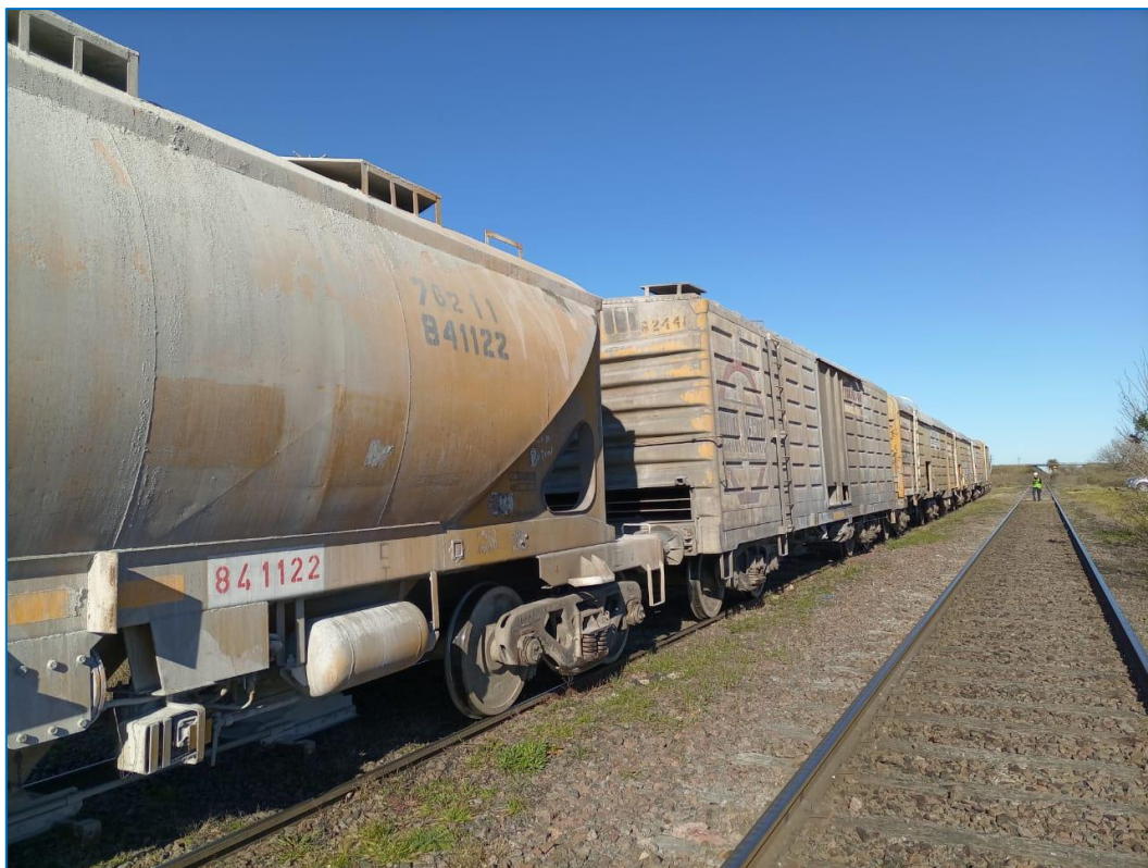
Figura 4. Vagón tolva cementera cilíndrica de 41 m 3 fabricado por FAVYS. Fuente: Archivo JST
