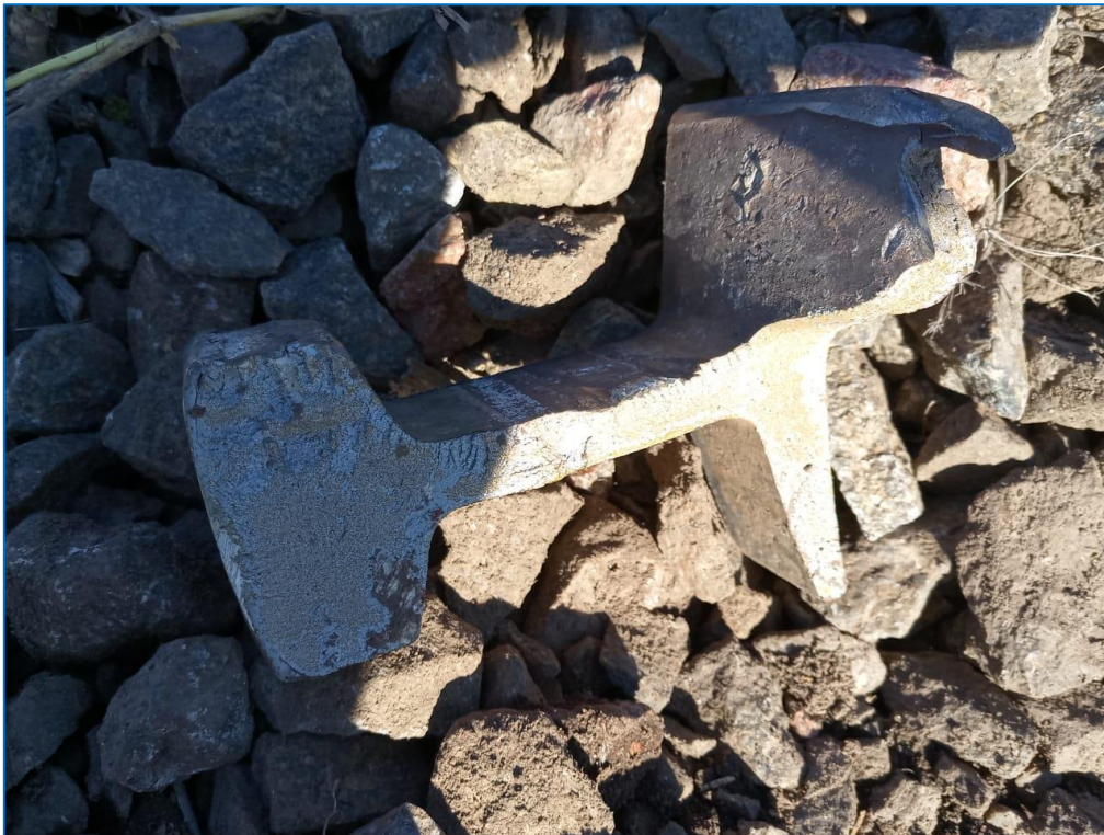
Figura 6. Pieza de un riel partido. Fuente: Archivo JST
