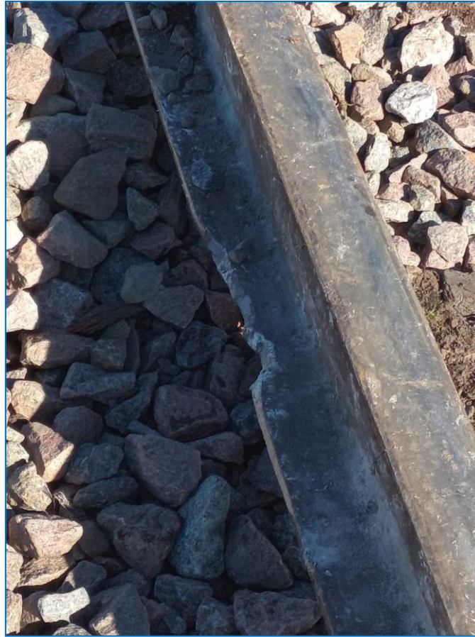
Figura 7. Marcas sobre el patín del riel a la altura del descarrilamiento. Fuente: Archivo JST
