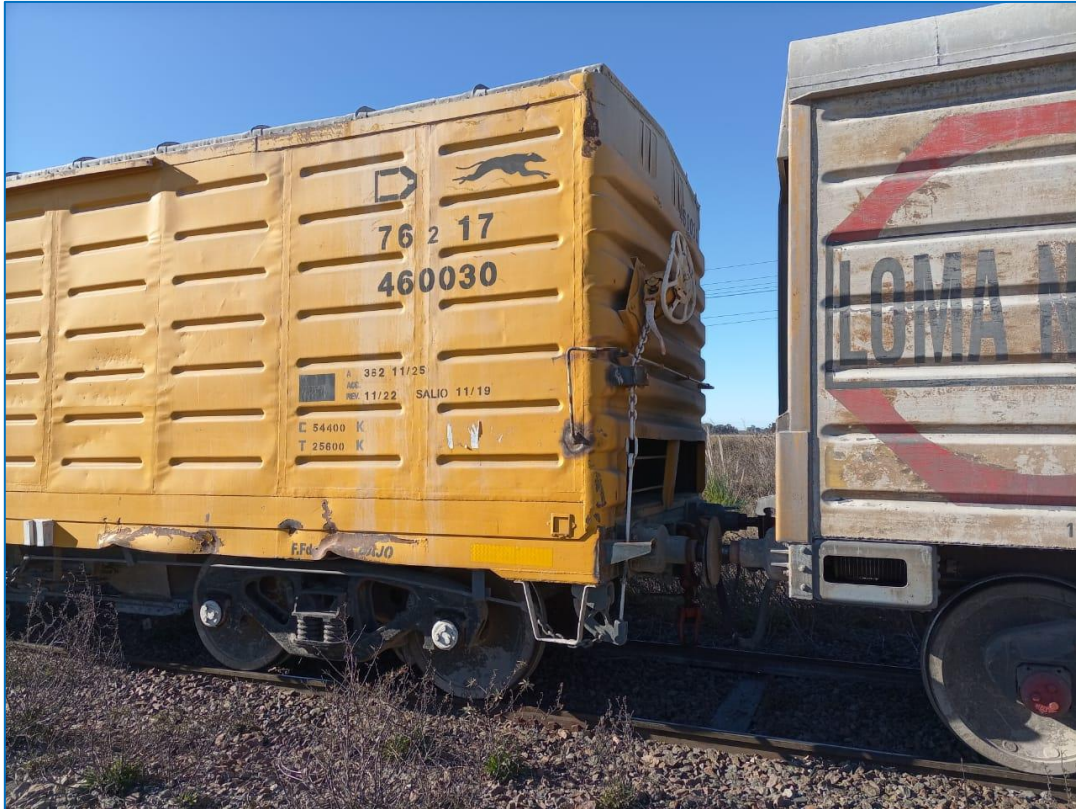
Figura 3. Vagón tipo cubierto todo uso de Industria Nacional, modificado a tolva cementera. Fuente: Archivo JST
