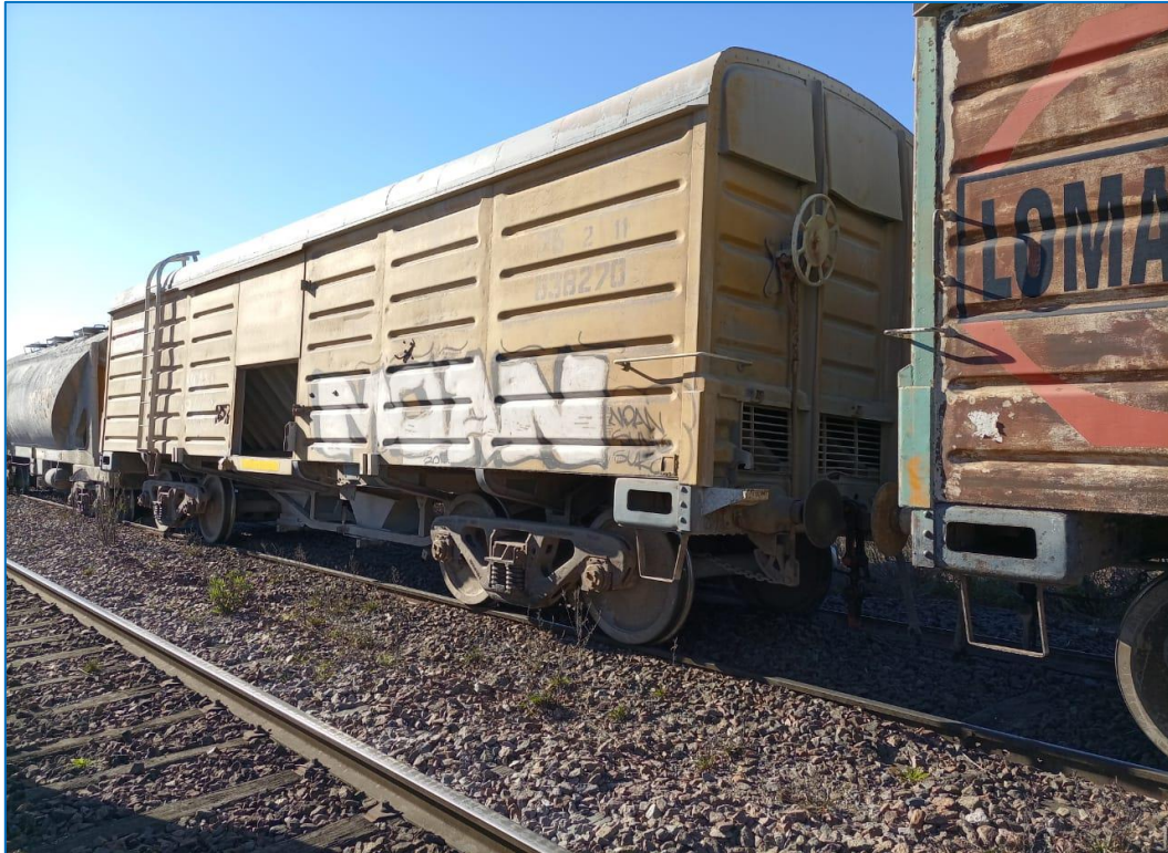
Figura 5. Vagón cubierto todo uso fabricado por Metropolitan Cammell, modificado a tolva cementera.
