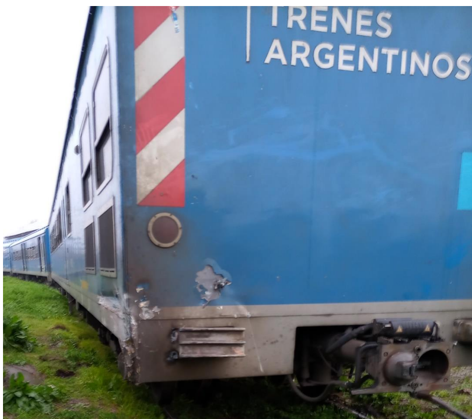
Figura 10. Daños en coche FU5009 de la formación 1 ubicada en la vía 5. Fuente: JST, 2021
