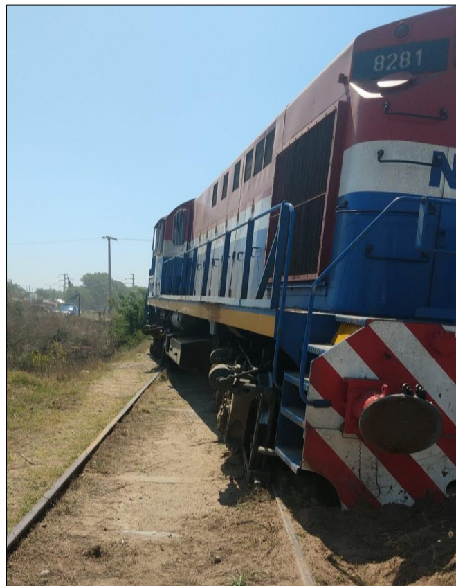
Figura 2. Ruedas del lado derecho de la locomotora en sentido de la marcha del tren en contacto con el interior del riel izquierdo. Fuente: JST, 2021
