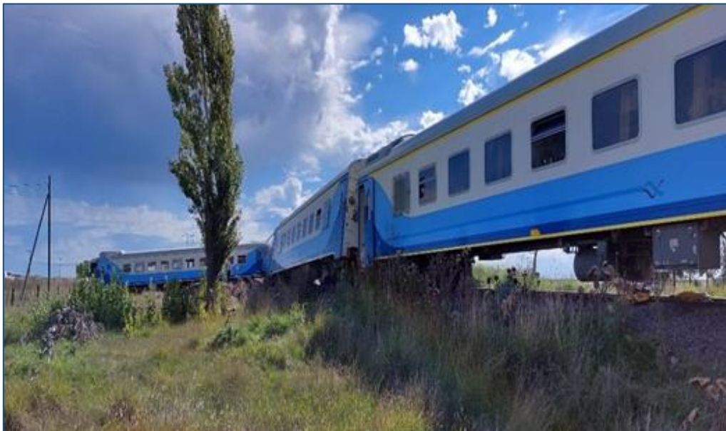
Figura 1. Coches descarrilados del tren 333. Fuente: JST, 2022
