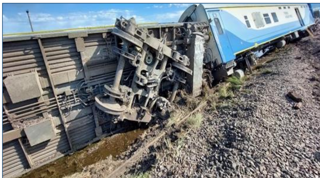
Figura 145. Coche PUA025 volcado sobre el margen de la vía y coche Furgón (FS013) descarrilado. Fuente: JST, 2022
