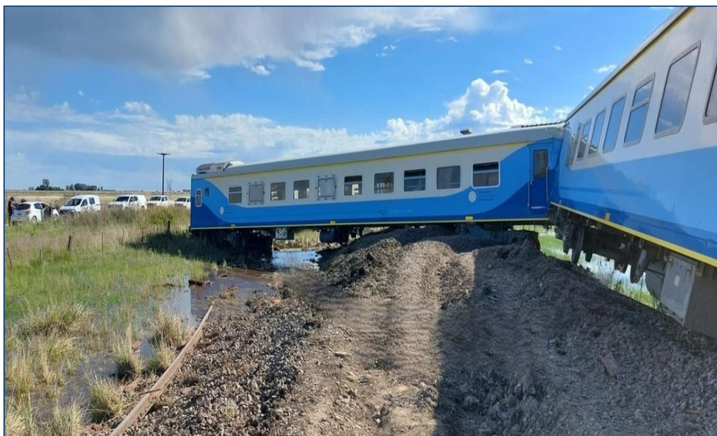
Figura 5. Agua acumulada a ambos lados del terraplén. Fuente: JST, 2022
