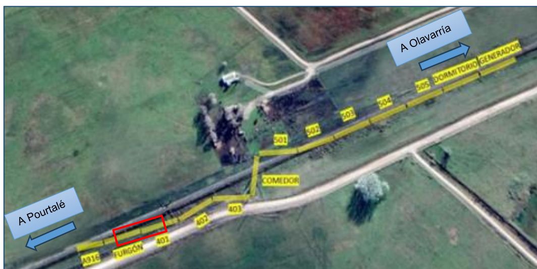
Figura 157. Croquis de la posición final de los coches afectados y del posible punto de inicio del descarrilamiento. Fuente: JST, 2022
