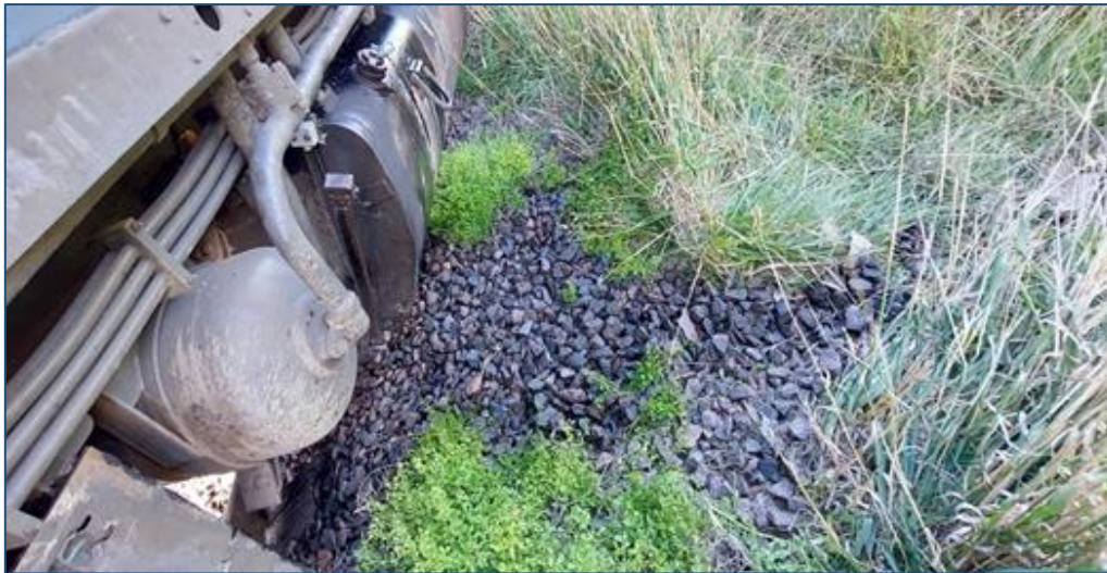
Figura 16. Pérdida de combustible de la locomotora A916. Fuente: JST, 2022
