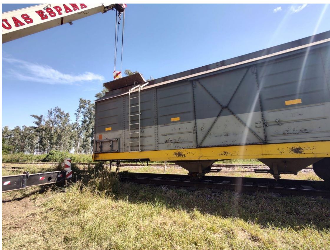
Figura 2. Tareas de encarrilamiento con grúa vial. Fuente: JST, 2022
