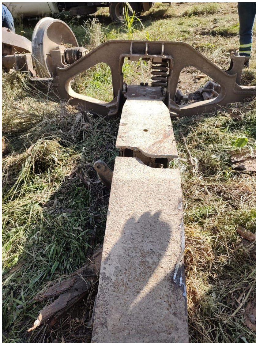
Figura 5. Bogie n.º 1 del vagón 645176 afectado por el suceso. Fuente: JST, 2022
