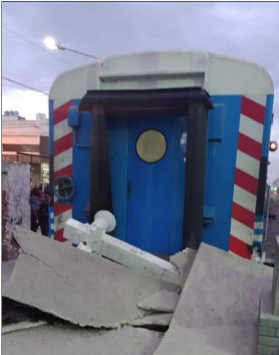
Figura 2. Daños en el andén 7 y en el FDV de la vía 5. Fuente: SOFSE, 2022
