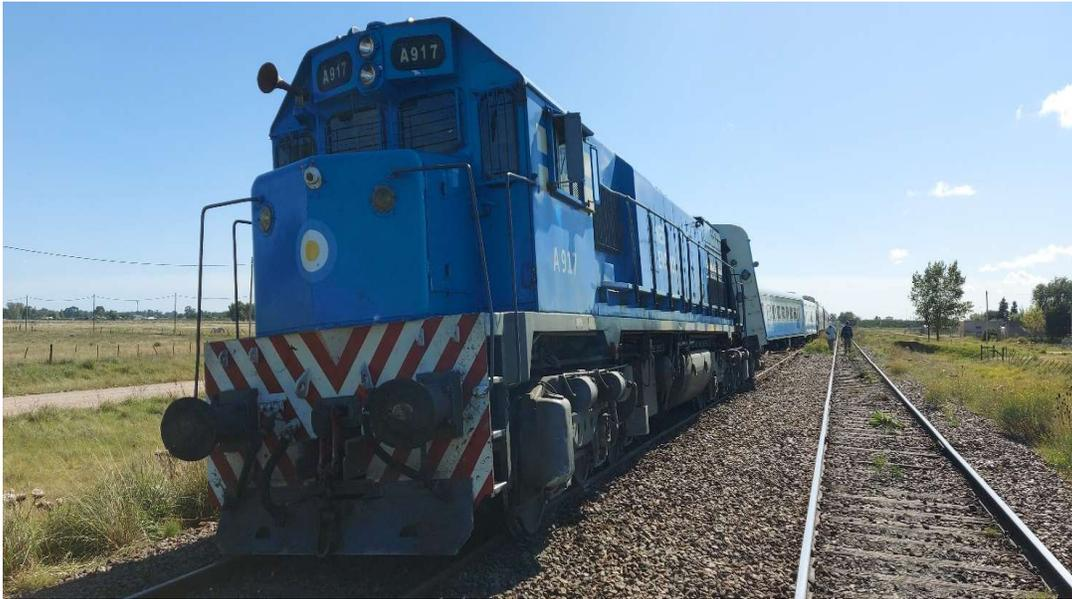
Figura 2. Locomotora A917, modelo GT22 CW-2. Fuente: JST, 2023
