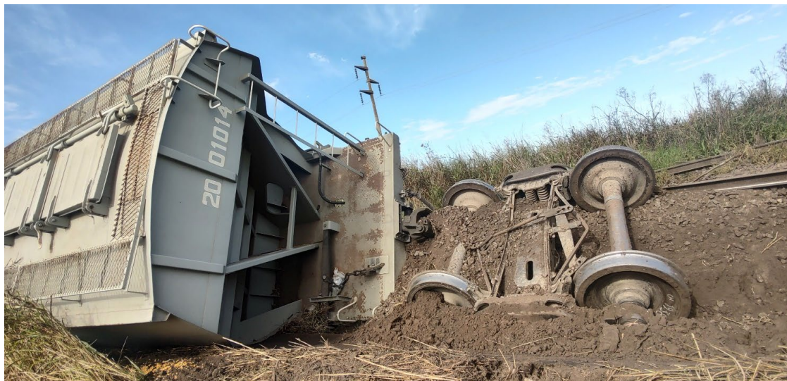
Figura 4. Daños en uno de los 13 vagones descarrilados. Fuente: JST, 2023
