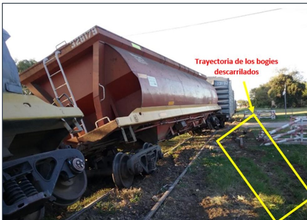
Figura 8. Detalle de la trayectoria de los bogies descarrilados del vagón 325076. Fuente: JST, 2023
