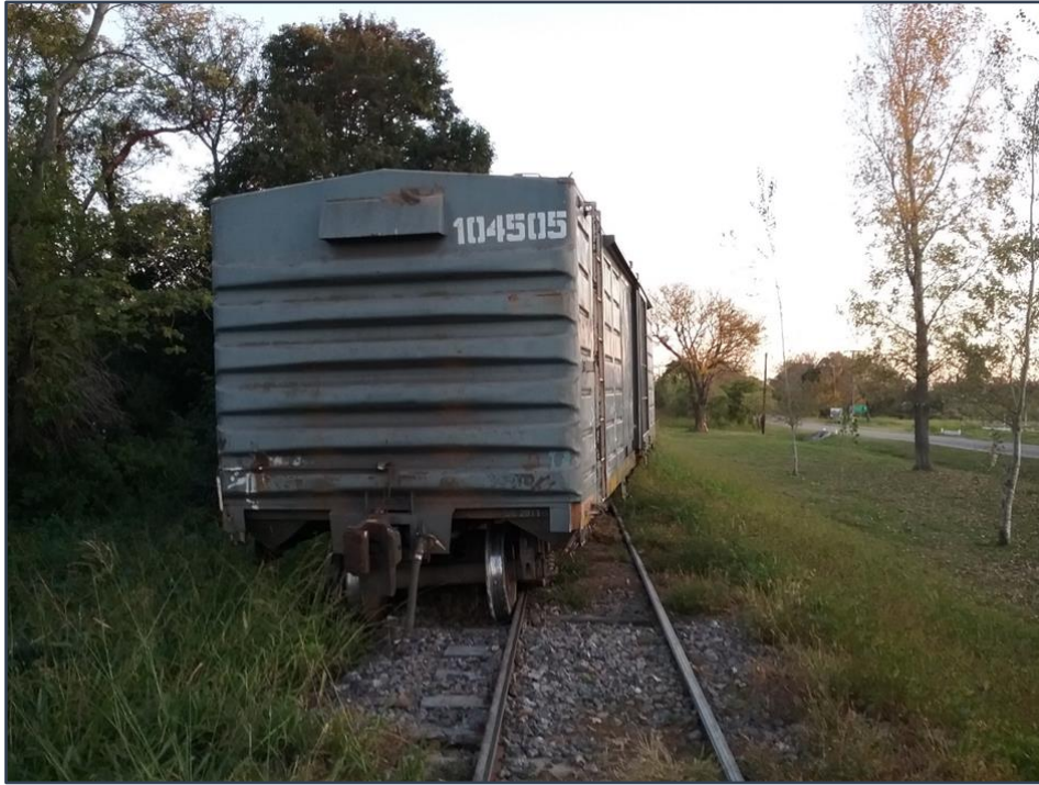
Figura 7. Bogie trasero descarrilado del vagón 104505. Fuente: JST, 2023
