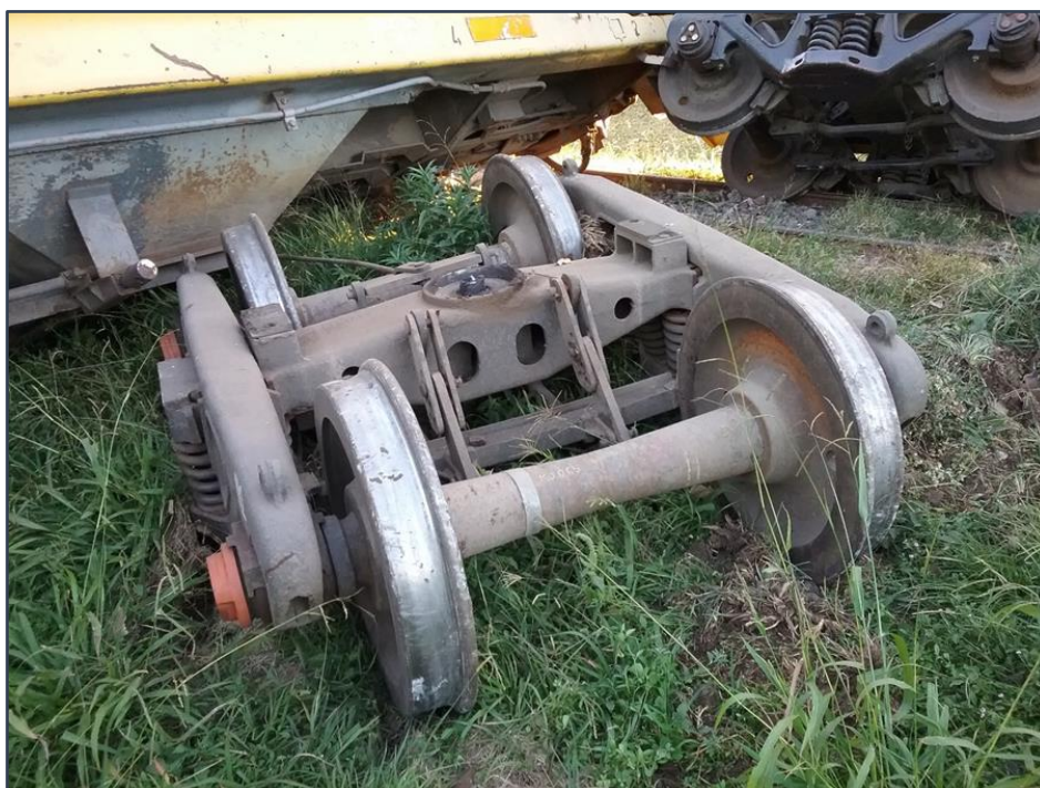
Figura 5. Bogie trasero desprendido del vagón 325076. Fuente: JST, 2023
