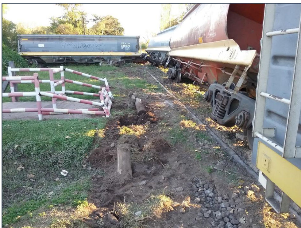
Figura 11. Daños en el laberinto peatonal del PAN de la RP 17. Fuente: JST, 2023
