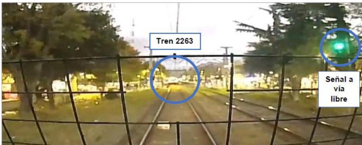
Figura 1. Señal a vía libre y tren 2263 detenido en la plataforma. Fuente: SOFSE, 2023
