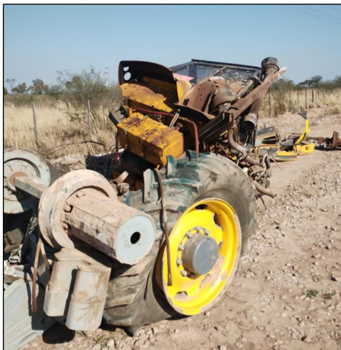
Figura 4. Tractor Pauny con equipo bi-vial afectado por el choque. Fuente: JST, 2023
