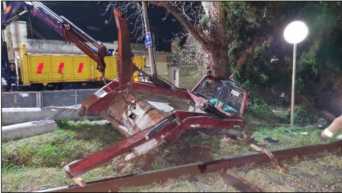
Figura 4. Estado de brazos portavolquetes postcolisión. Fuente JST, 2023
