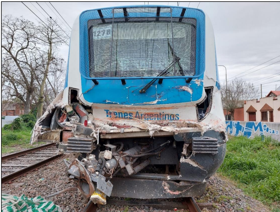
Figura 3. Daños en la cabina 127B. Fuente: JST, 2023
