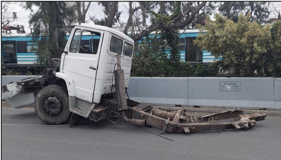
Figura 8. Cabina y chasis del camión afectados por la colisión. Fuente: JST, 2023
