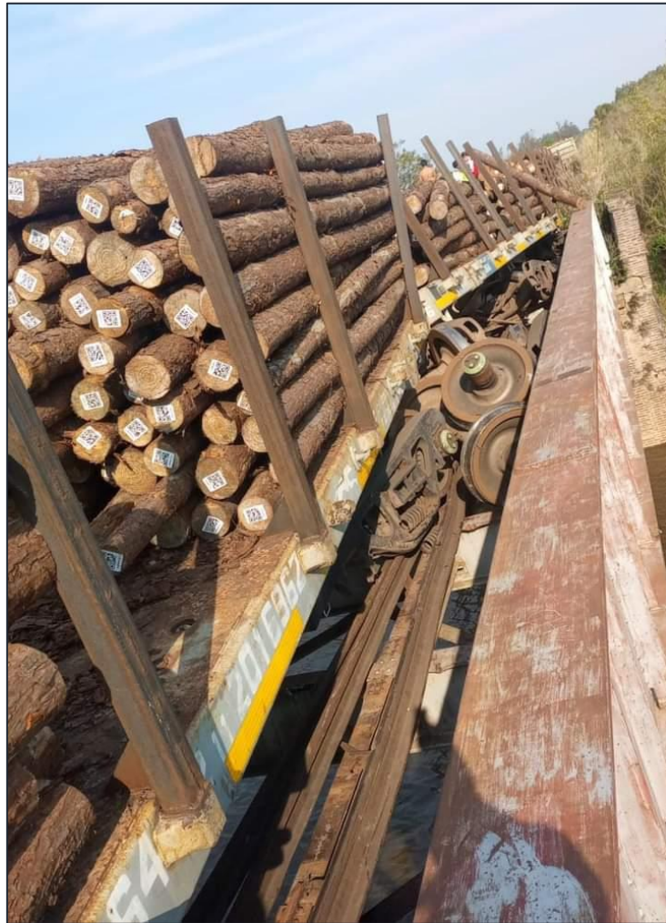
Figura 2. Desprendimiento de pares montados y boguies sobre el tramo metálico del puente. Fuente: Crónica Ferroviaria
