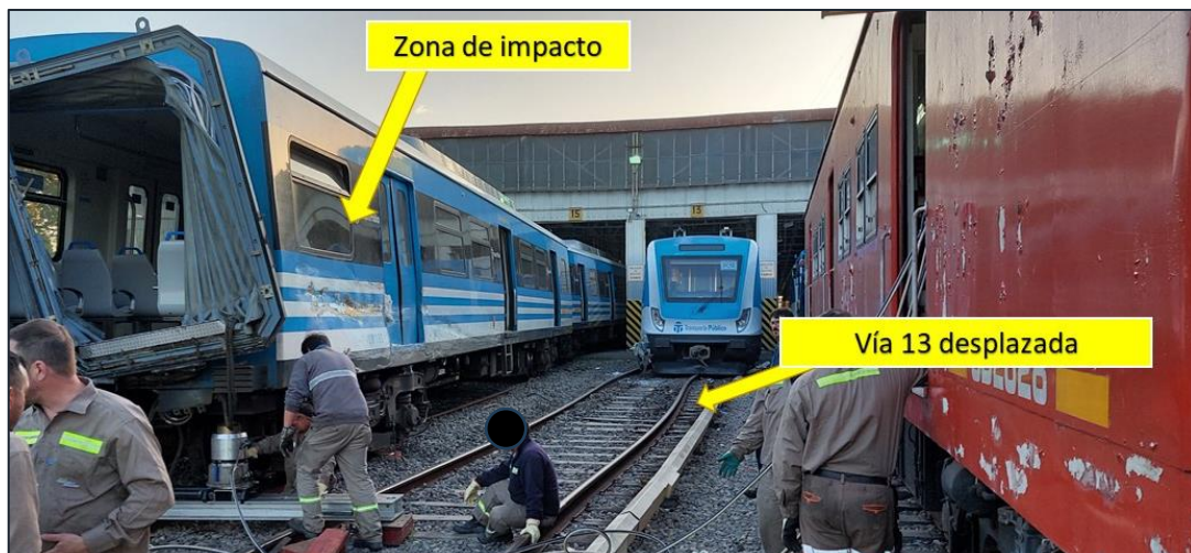
Figura 3. Marcas de impacto en el lateral izquierdo de la formación RC19 y desplazamiento de la vía 13. Fuente: JST, 2023
