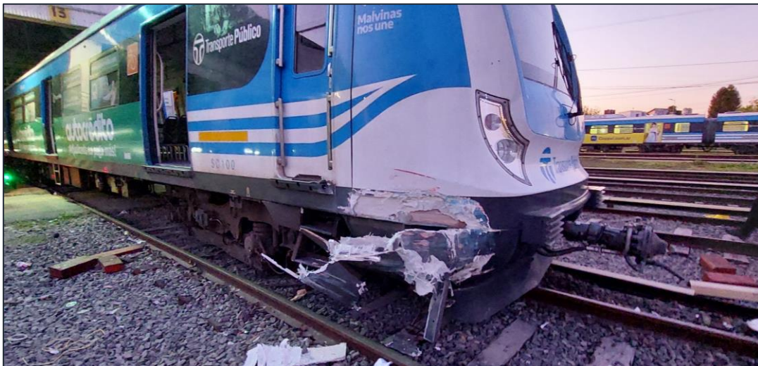
Figura 2. Daños registrados en el lateral derecho de la formación RC12. Fuente: JST, 2023
