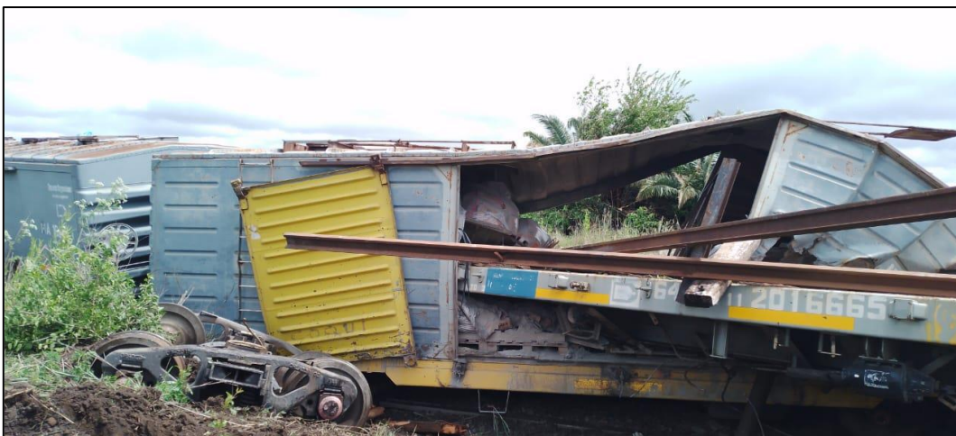
Figura 3. Vagones incrustados entre sí con desprendimiento de bogies. Fuente: JST, 2023
