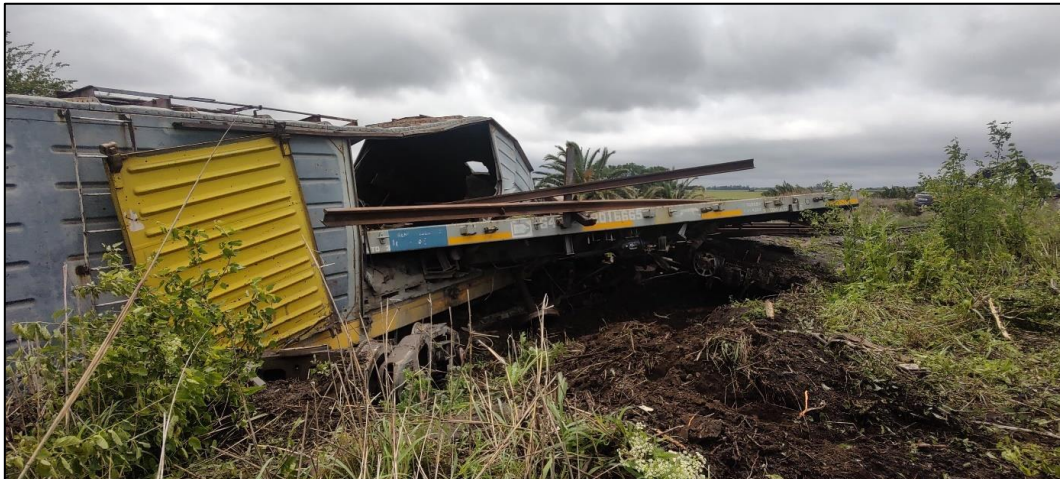
Figura 6. Deformación de la estructura de la caja de uno de los vagones. Fuente: JST, 2023
