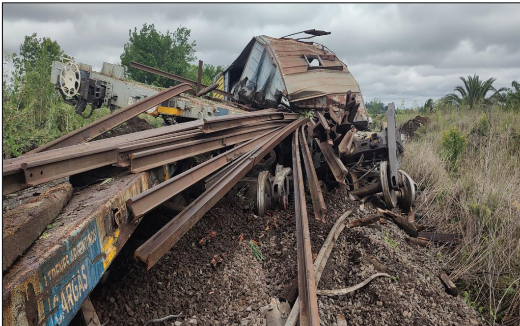
Figura 1. En la imagen se observa la pérdida de carga de rieles de uno de los vagones afectados por el descarrilamiento. Fuente: JST, 2023
