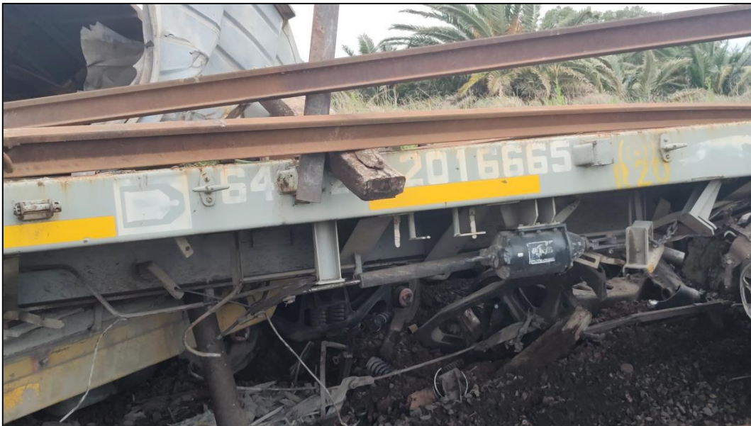
Figura 5. Dispersión de partes de un bogie fracturado por el suceso. Fuente: JST, 2023
