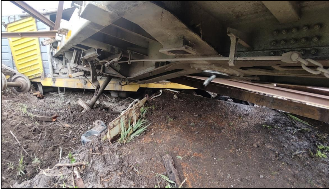
Figura 4. Daños en el material rodante ocasionados por el suceso. Fuente: JST, 2023
