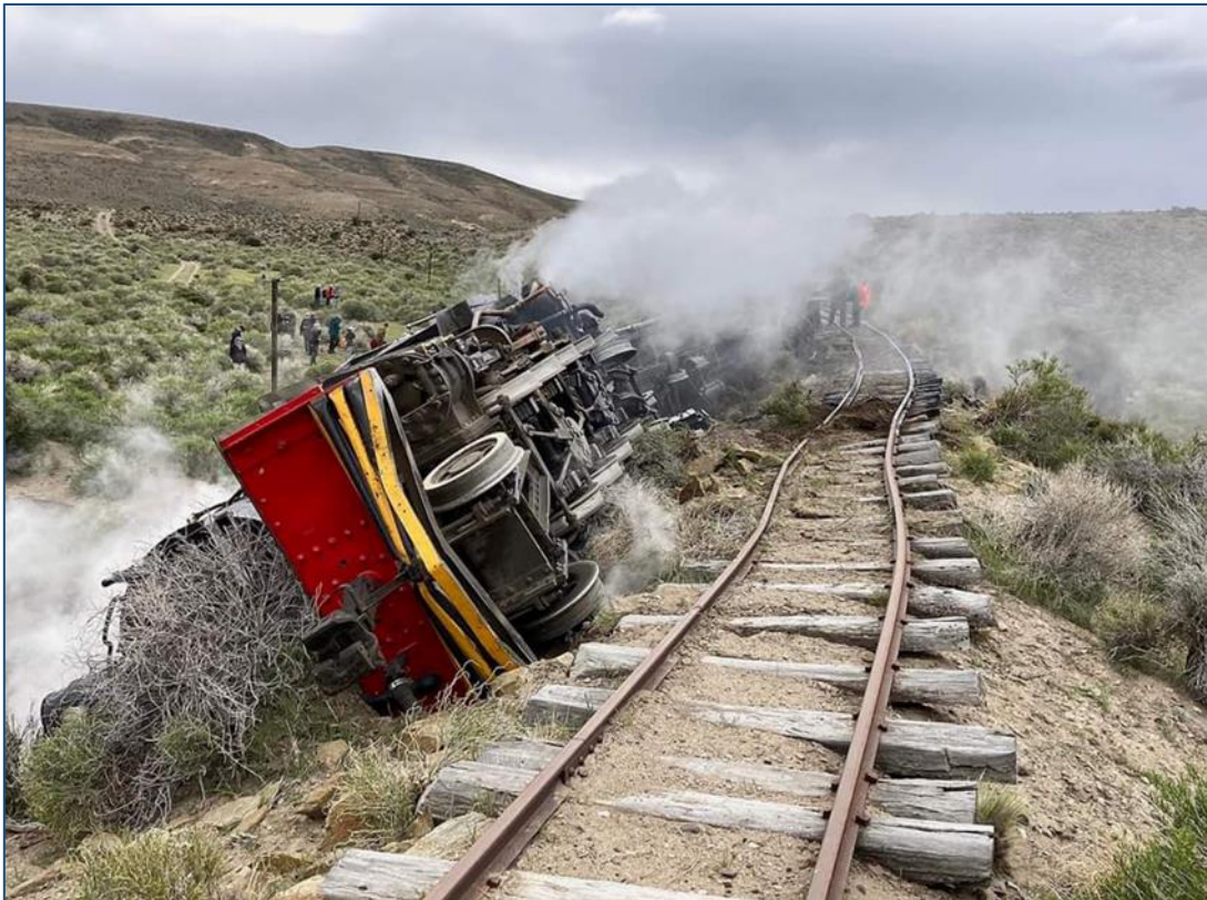
Figura 1. Imagen de tren 376 descarrilado y volcado sobre el margen de la vía en sentido a Esquel.
