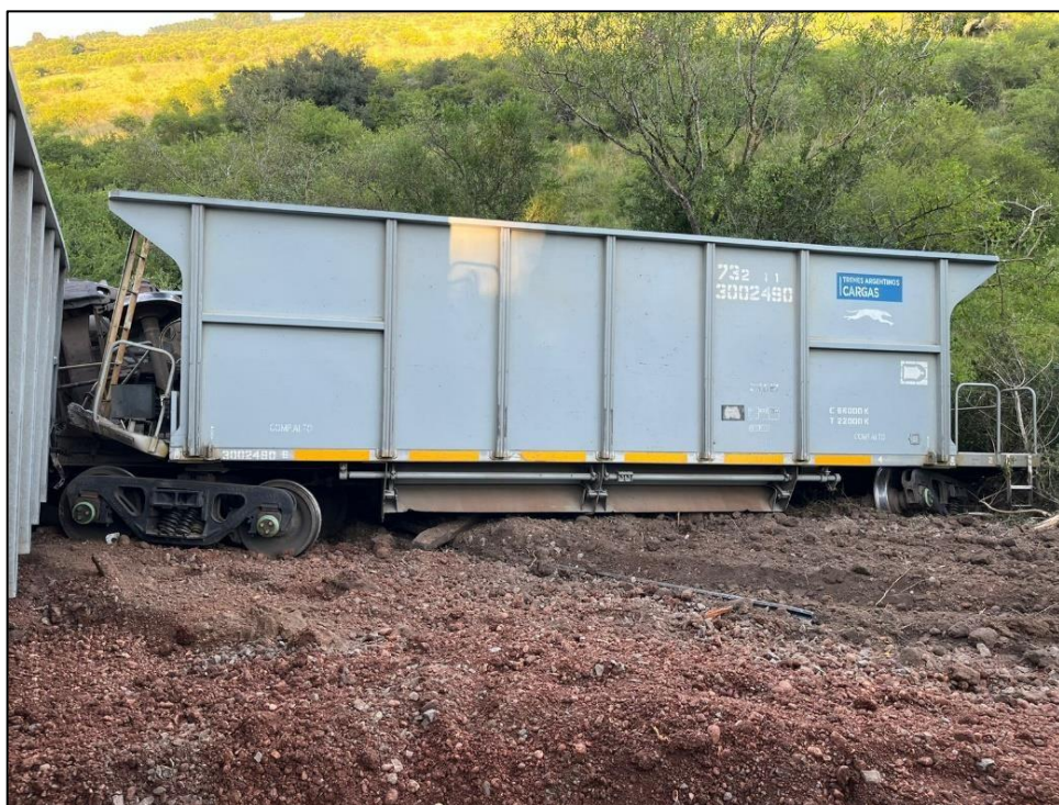
Figura 4. Daños en los bogies de los vagones afectados. Fuente: JST, 2024
