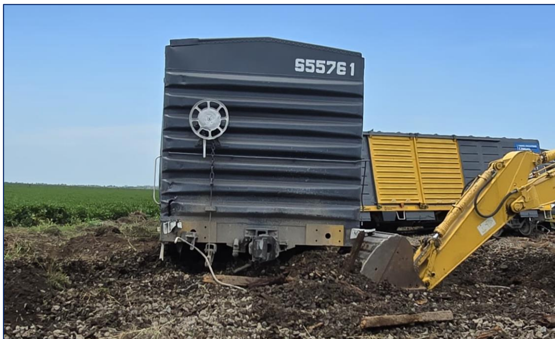
Figura 3. Vagón descarrilado con desprendimiento de bogie. Fuente: JST, 2024
