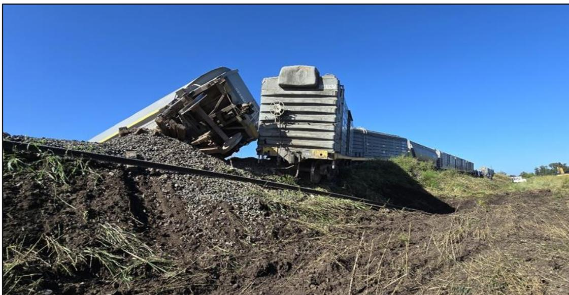
Figura 5. Distribución zigzagueante de los vagones con respecto al eje de la vía.
