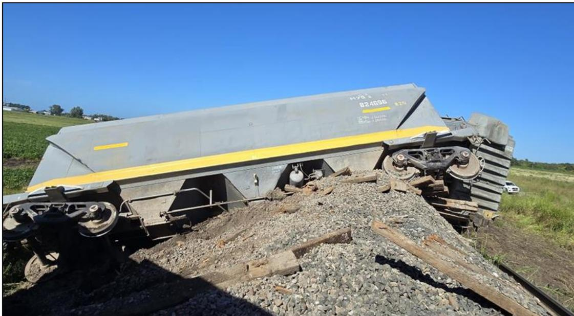
Figura 6. Bogies descarrilados del vagón 824656. Fuente: JST, 2024
