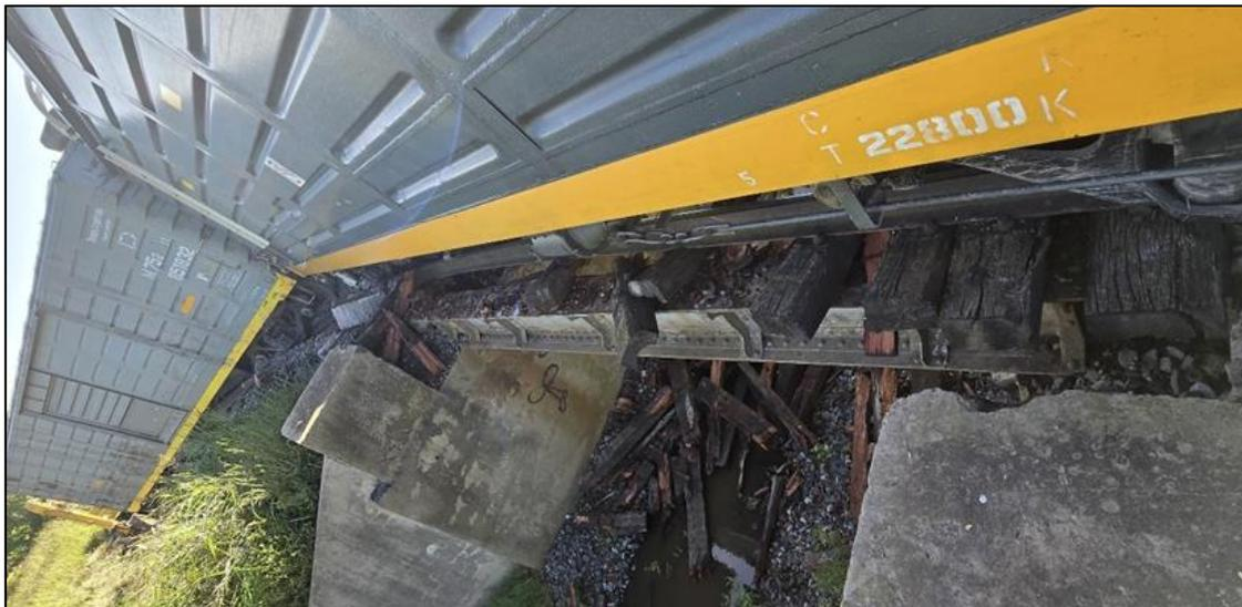
Figura 4. Vagón descarrilado sobre alcantarilla. Fuente JST, 2024
