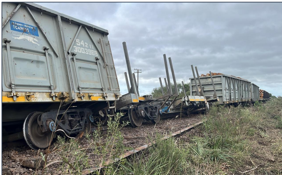
Figura 3. Deformación de rieles, rotura de durmientes y fijaciones. Descarrilamiento de vagones de borde alto y vagones abiertos. Fuente: JST, 2024
