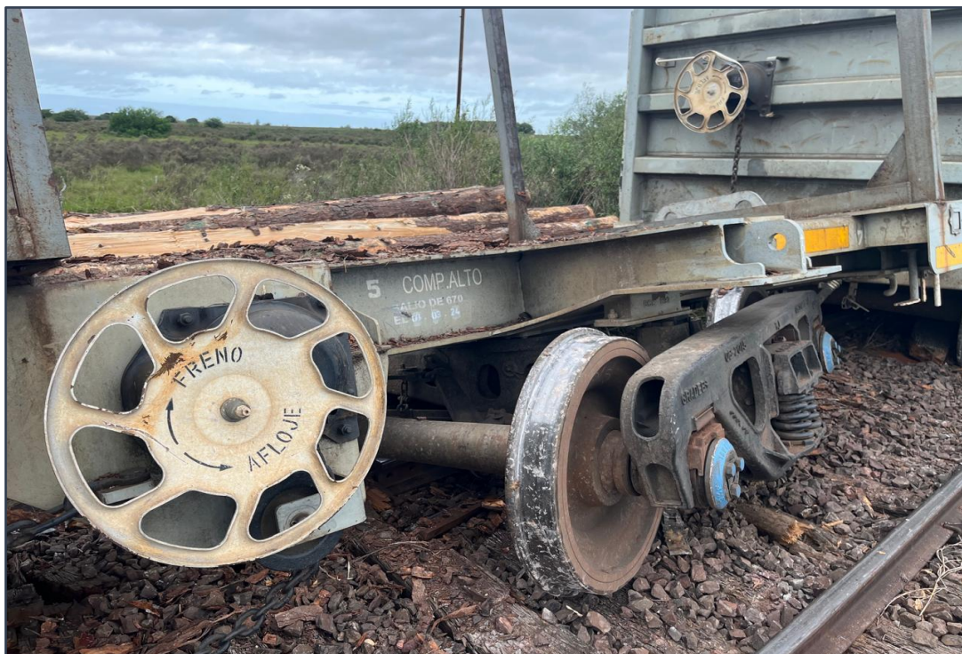
Figura 2. Se observan deformaciones de rieles, rotura de durmientes, placas de asiento y fijaciones. Desprendimientos de bogies en vagones afectados. Fuente: JST, 2024
