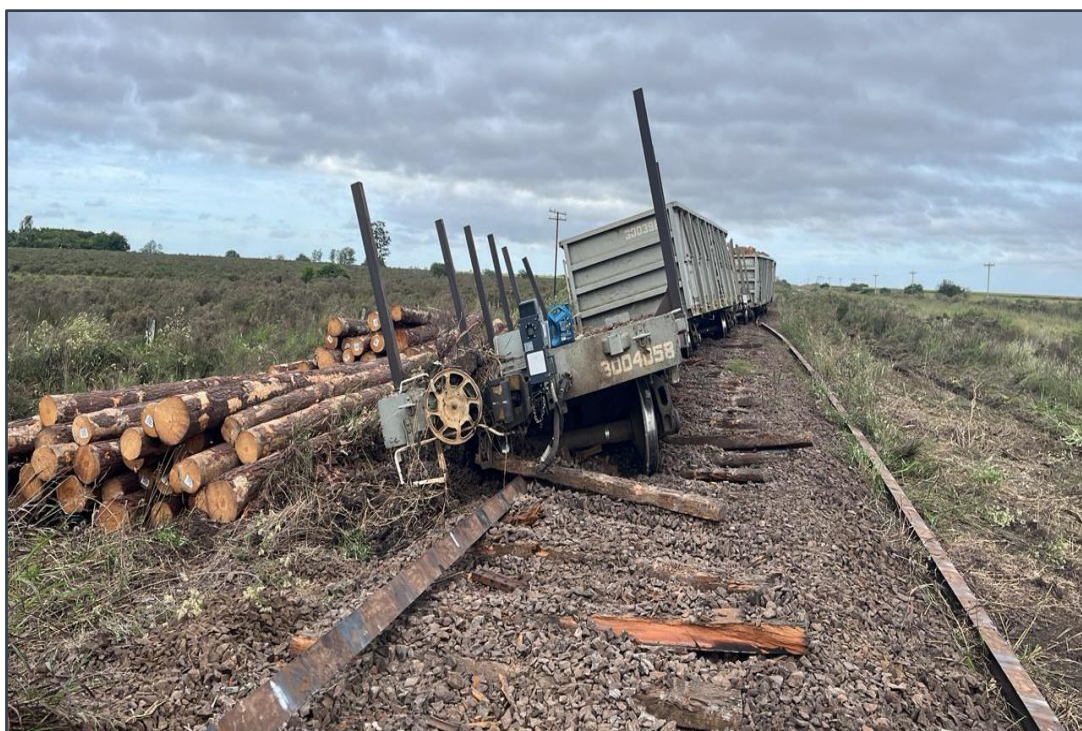
Figura 1. Estado de la superestructura de vía, vagones y rollizos de pinos luego del accidente.
