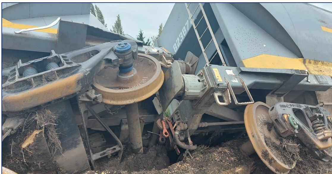
Figura 5. Vagones n.º 827642 y n.º 823872 semivolcados hacia la derecha en el sentido de circulación. Fuente: JST, 2024
