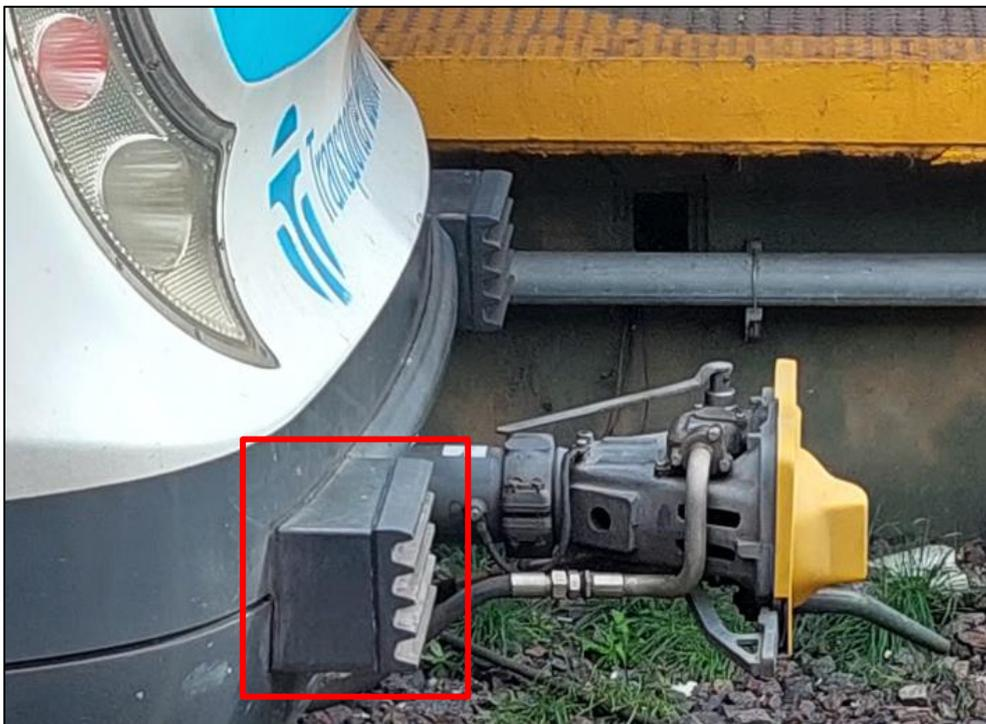
Figura 34. Dispositivo antiacaballamiento – Diseño tipo A. Fuente: JST, 2025
