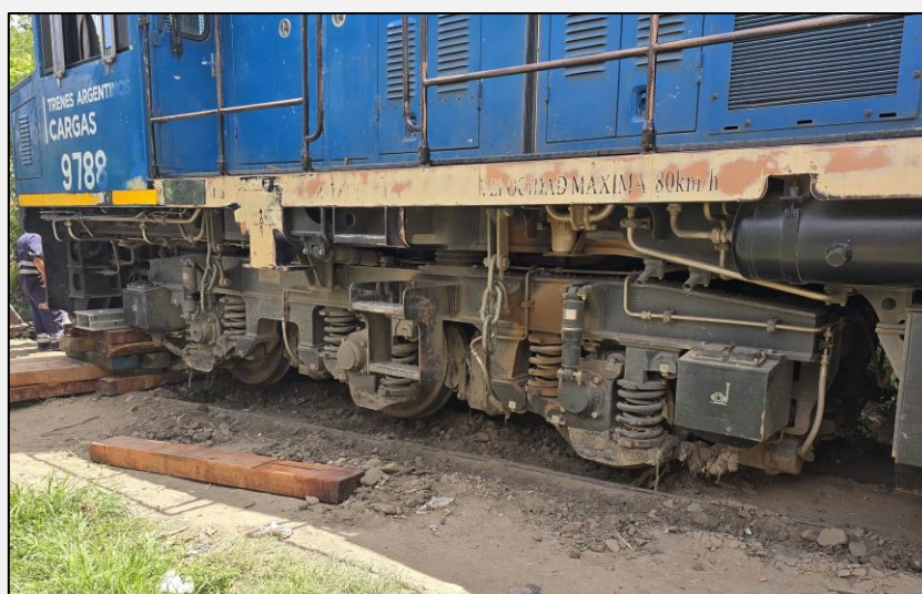
Figura 2. Trabajos de encarrilamiento de la locomotora titular del tren 5002. Fuente: JST, 2024
