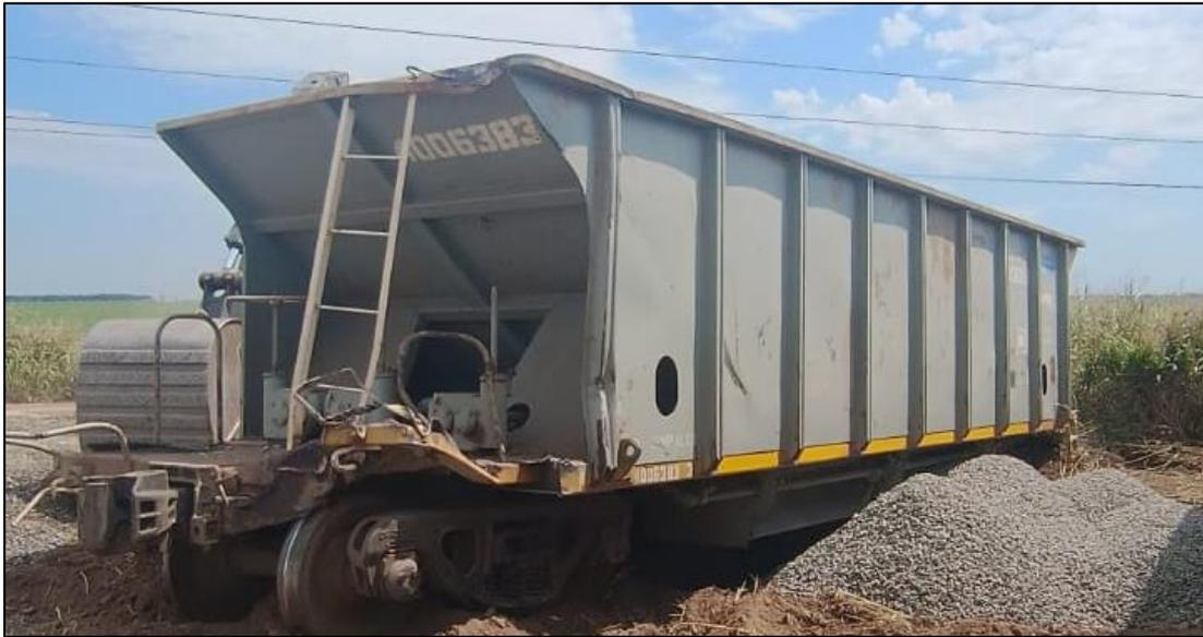
Figura 3. Vagón 4006383 descarrilado con daños visibles en su plataforma, tolva y barandas. Fuente: JST, 2025
