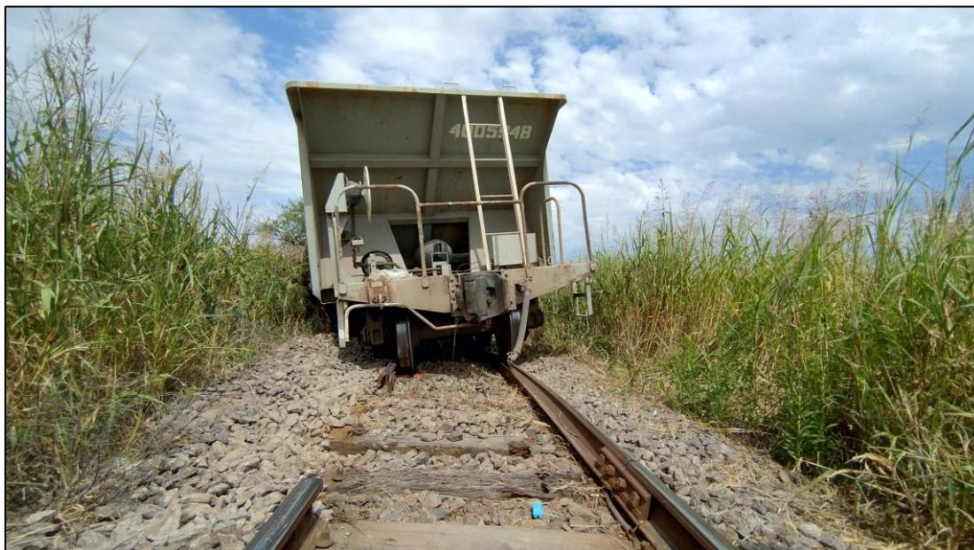
Figura 5. Daños en la infraestructura a la altura de vagón 4005948. Fuente: JST, 2025
