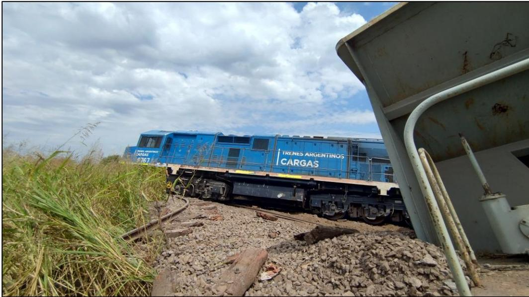
Figura 6. Daños en la infraestructura a la altura de la locomotora remolcada.
