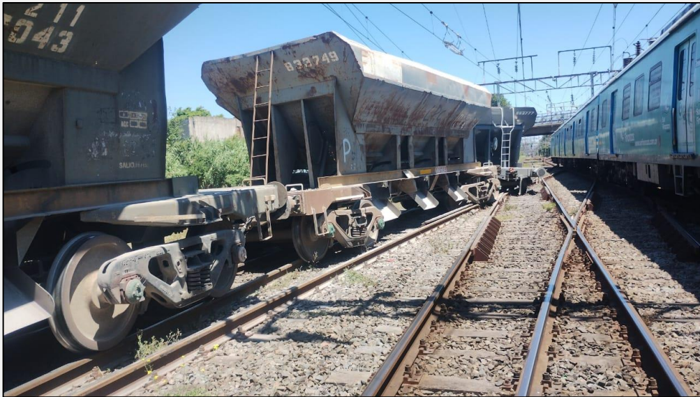
Figura 1. Vista de los vagones descarrilados y la interrupción de las vías 1 y 2.
