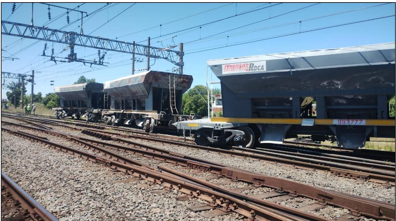
Figura 1. Vagones descarrilados sobre el cambio de salida de la playa. Fuente: JST, 2025.
