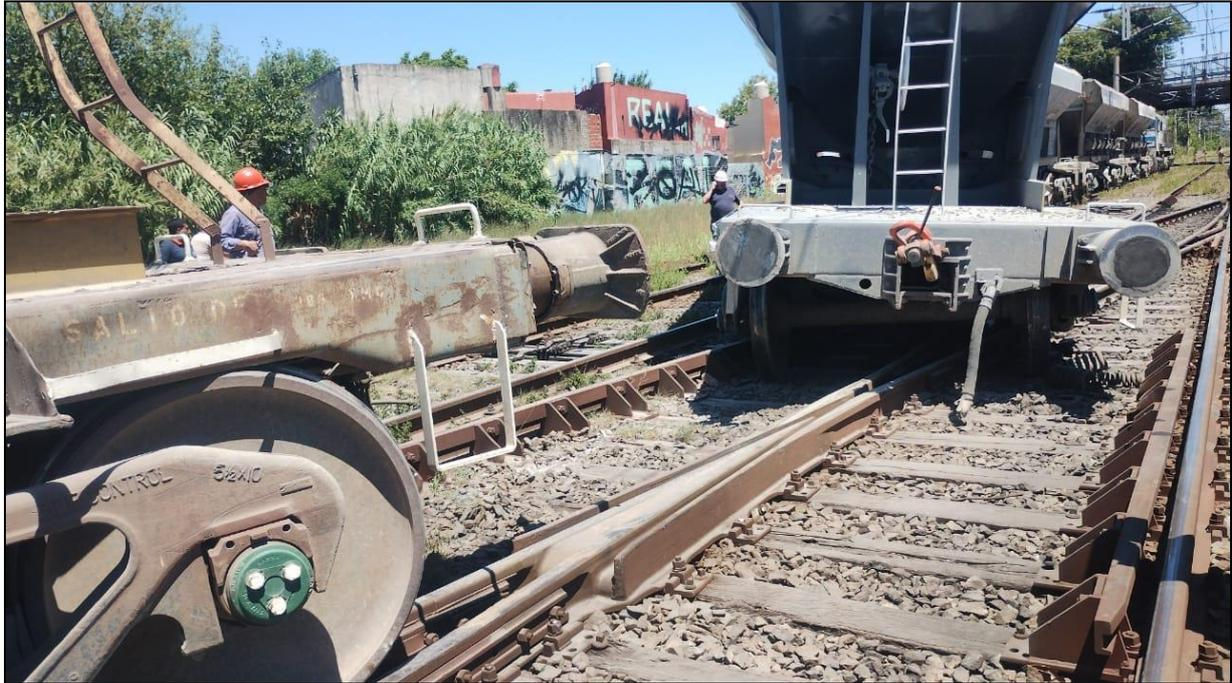
Figura 3. Vista de los vagones descarrilados. Fuente: JST, 2025.
