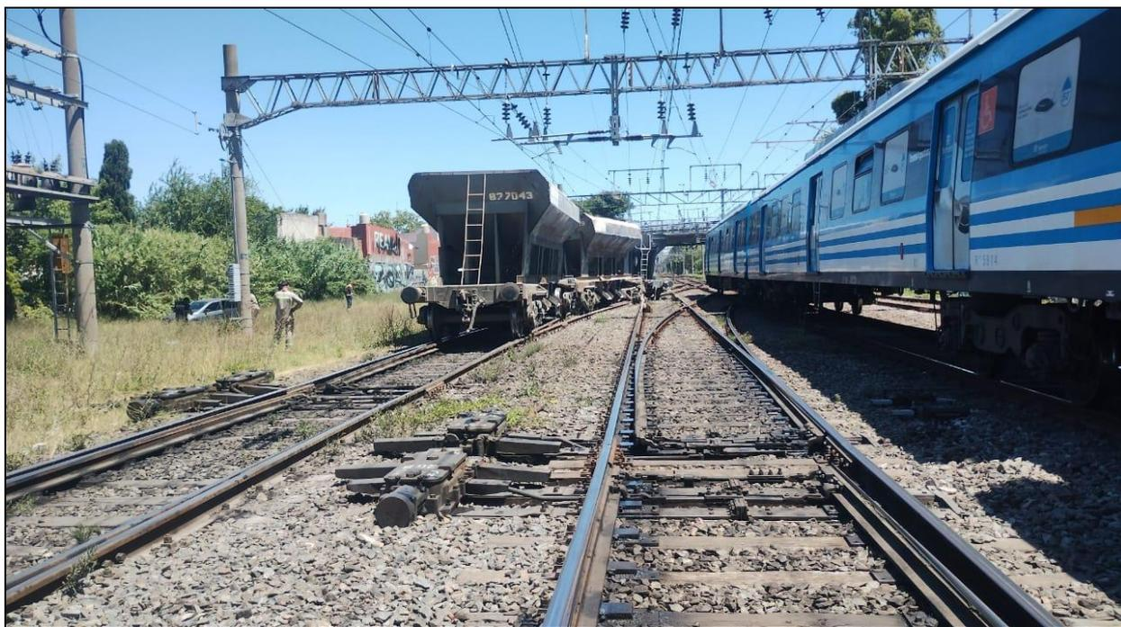
Figura 2. Vista de la invasión de gálibo por parte del tren de carga 113. Fuente: JST, 2025.
