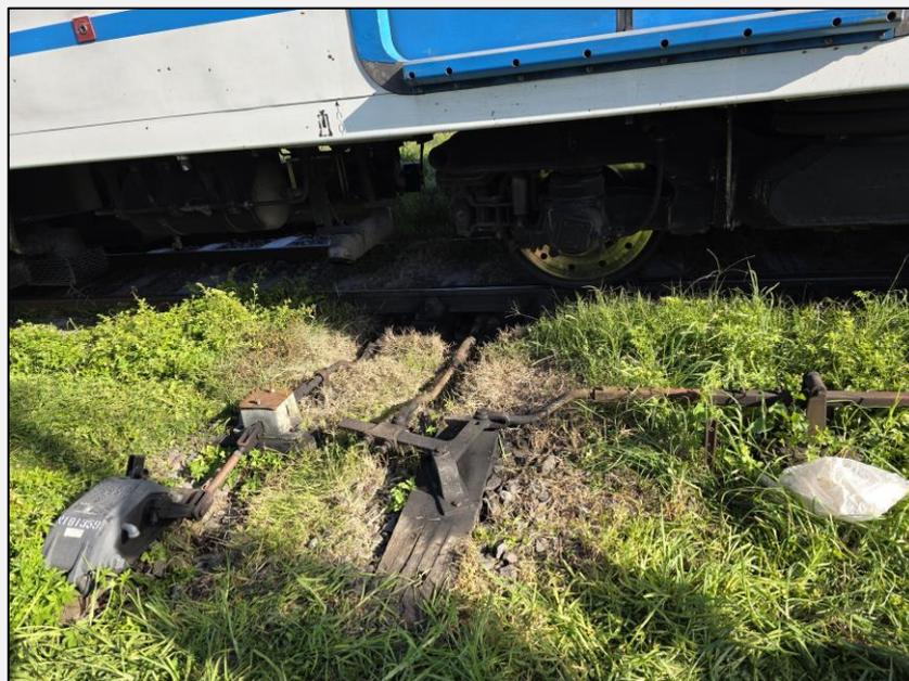
Figura 2. Vista parcial del tren sobre la trampa y mecanismos asociados al dispositivo. Fuente: JST, 2025
