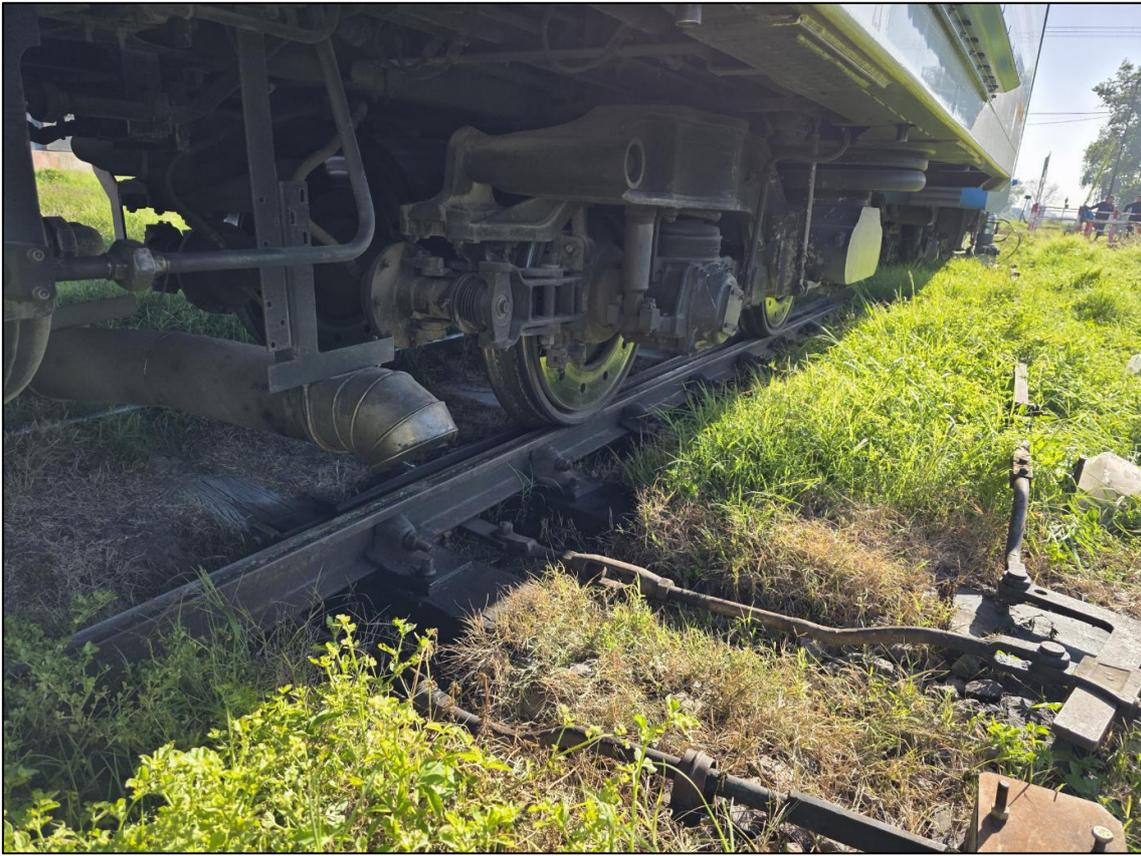
Figura 2. Descarrilamiento a la altura del primer bogie del segundo coche, en sentido a la estación Dr. Sáenz. Fuente: JST, 2025
