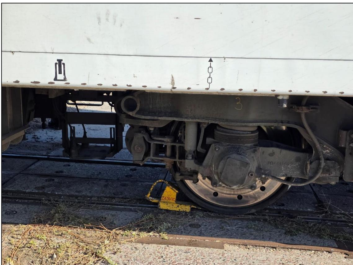
Figura 3. Marcas de impacto en los componentes ubicados debajo de la carrocería del primer coche. Fuente: JST, 2025
