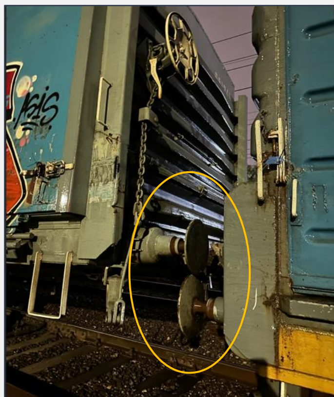
Figura 3. Paragolpes del vagón n.º 651745 encimados con el vagón contiguo en sentido de marcha. Fuente: JST, 2025
