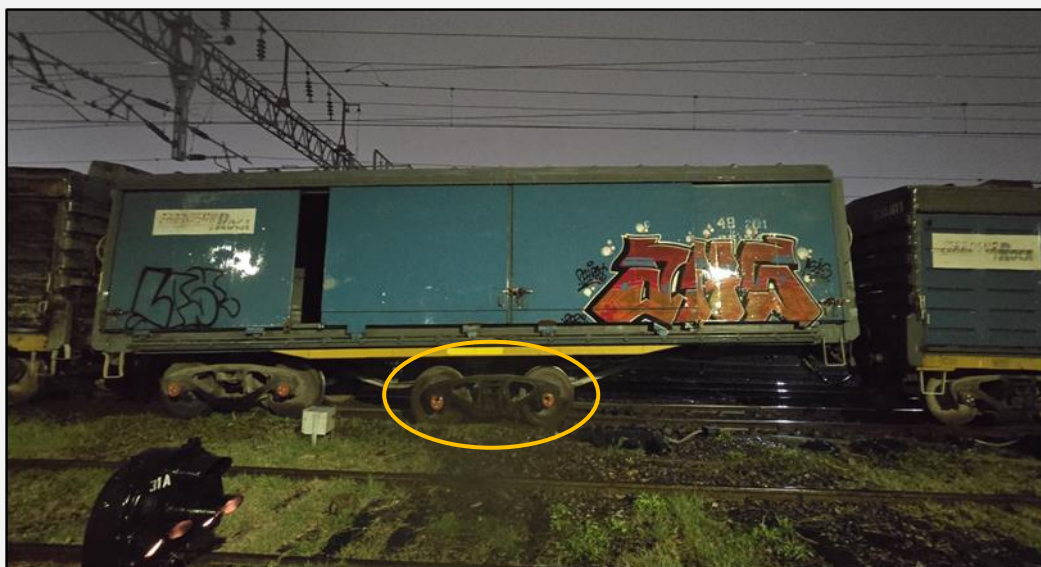
Figura 2. Vagón descarrilado n.º 651745, con desprendimiento de uno de sus bogies.
