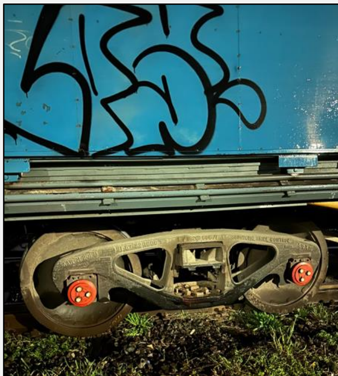
Figura 4. Pérdida de elementos de suspensión del vagón n.º 651745. Fuente: JST, 2025
