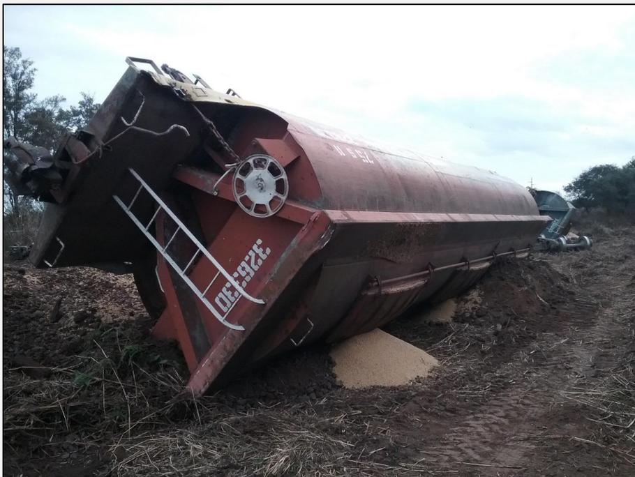
Figura 2. Vagón n.º 326330 volcado al costado de la vía con pérdida de carga.
