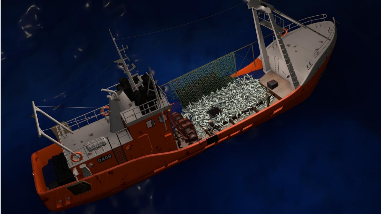
Figura 7. Recreación del Carmelo A. Bocas de desagüe tapadas por la captura.
