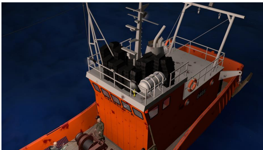
Figura 9. Recreación del Carmelo A. EPIRB y balsa obstruidos por cajones de pescado en la timonera.
