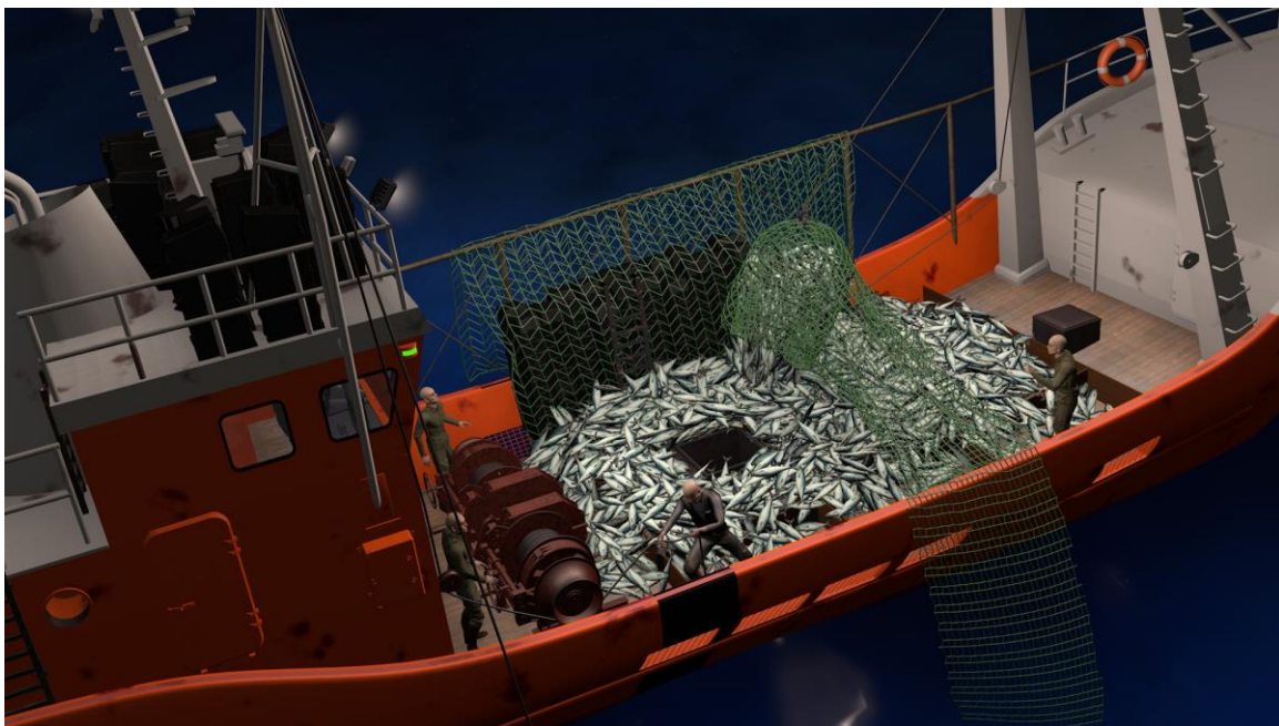
Figura 6. Recreación del Carmelo A. Apertura de la bolsa sobre babor en la cubierta al zafar la cuña.
