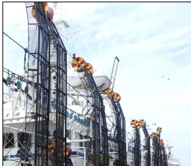
Figura 22. Buque Nanina, emplazamiento de las balsas salvavidas en la banda de estribor. Las parrillas están replegadas.
