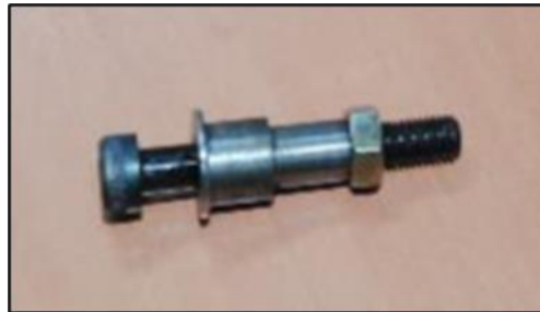
Figura 20. Perno de fijación de la unión articulada que vincula el actuador del regulador de velocidad electrónico a la cremallera de la bomba inyectora, perteneciente al motor auxiliar esencial N.º 3. Nótese la ausencia de la contratuerca de seguridad.
