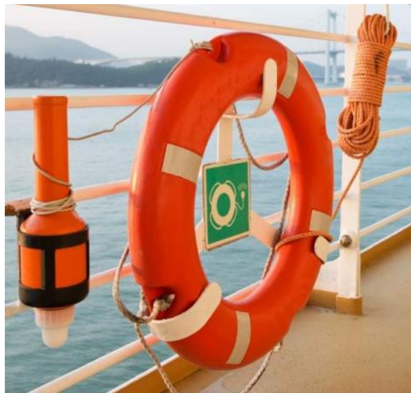
Figura 14. Imagen correspondiente a otra embarcación, se muestra solamente a modo ilustrativo para indicar la disponibilidad de un aro salvavidas con rabiza flotante (cabo) y guindola (luz)
