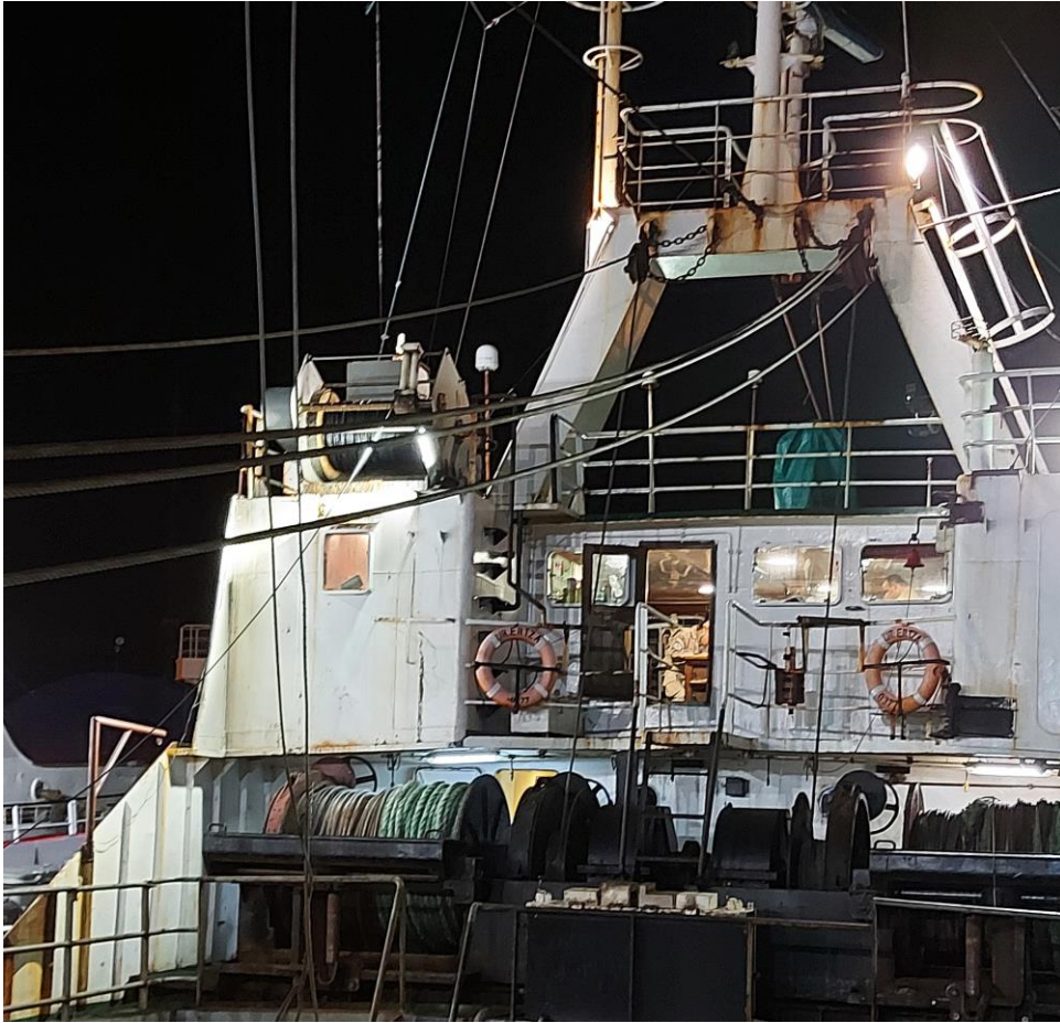
Figura 9. Foto de popa de la timonera donde se observan dos aros salvavidas
